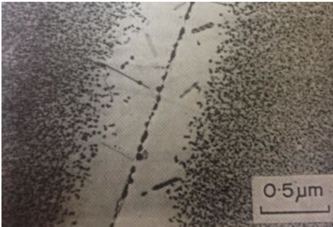
Figura 3.2. Zonas libres de precipitado a ambos lados de un borde de grano en una aleación, Al-4Zn-3Mg.
