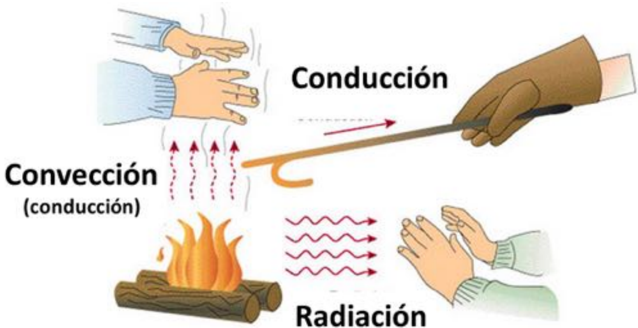
Fig. 2.4. Los tres tipos de transferencia de calor.
