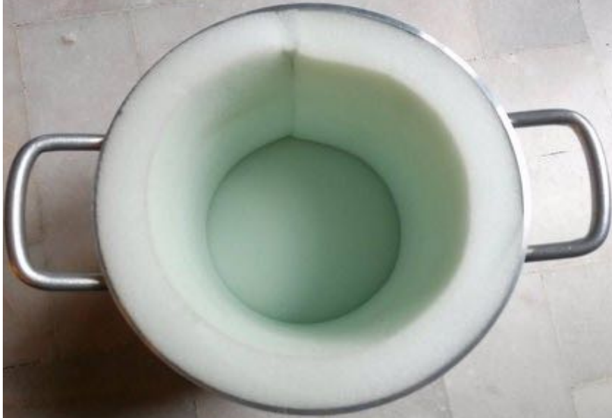
Figura 5.4. Aislante pegado al contenedor.
