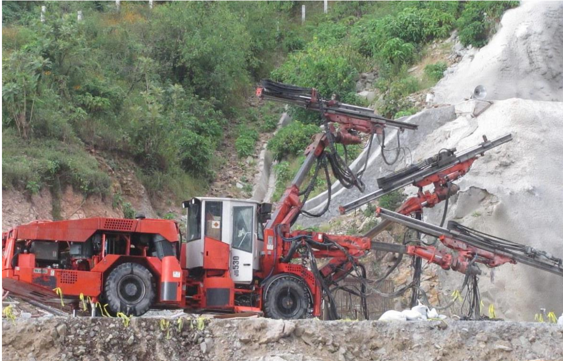
Fig. No. 93 Equipo de Barrenación (Jumbo de 3 brazos)
