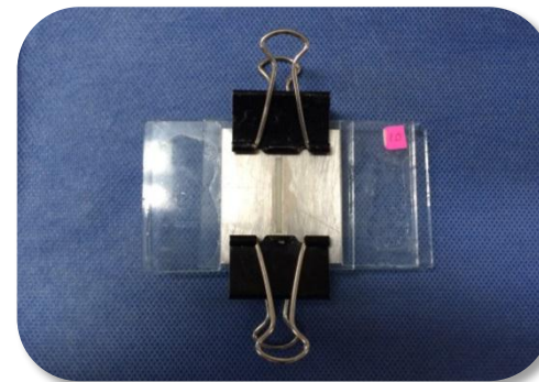
Figura 14. Colocación de cinta Myllar, placa de vidrio y grapas de presión.
