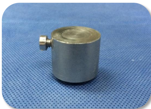
Figura 22. Molde para muestras de sorción y solubilidad.
