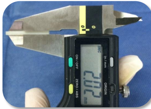
Figura 20. Medición de la altura ( h ).
