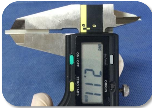
Figura 19. Medición del ancho ( b ).
