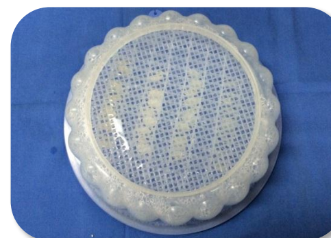
Figura 31. Sumersión de muestras en agua bidestilada por 7 días.
