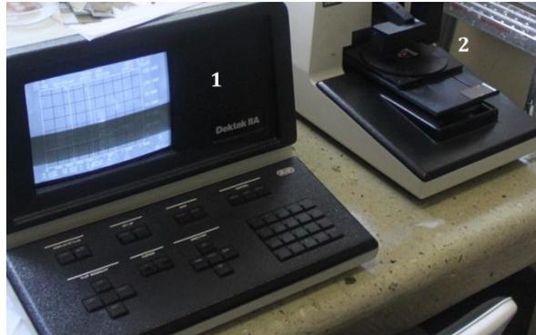
**Figura 3-6** Se muestra el perfilómetro usado para el estudio, cuenta con una pantalla para observar el perfil generado y controles para tomar medidas de la distancia sobre puntos del perfil (1), la muestra se colocó sobre la platina para el barrido lineal con la aguja (2).
