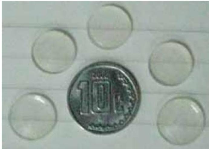
**Figura 3-3** Monolitos de sonogel de alta transparencia obtenidos de molde cilíndrico comparados en tamaño con una moneda de 10 centavos. La separación entre las líneas es de 5mm fotografía cortesía [16].
