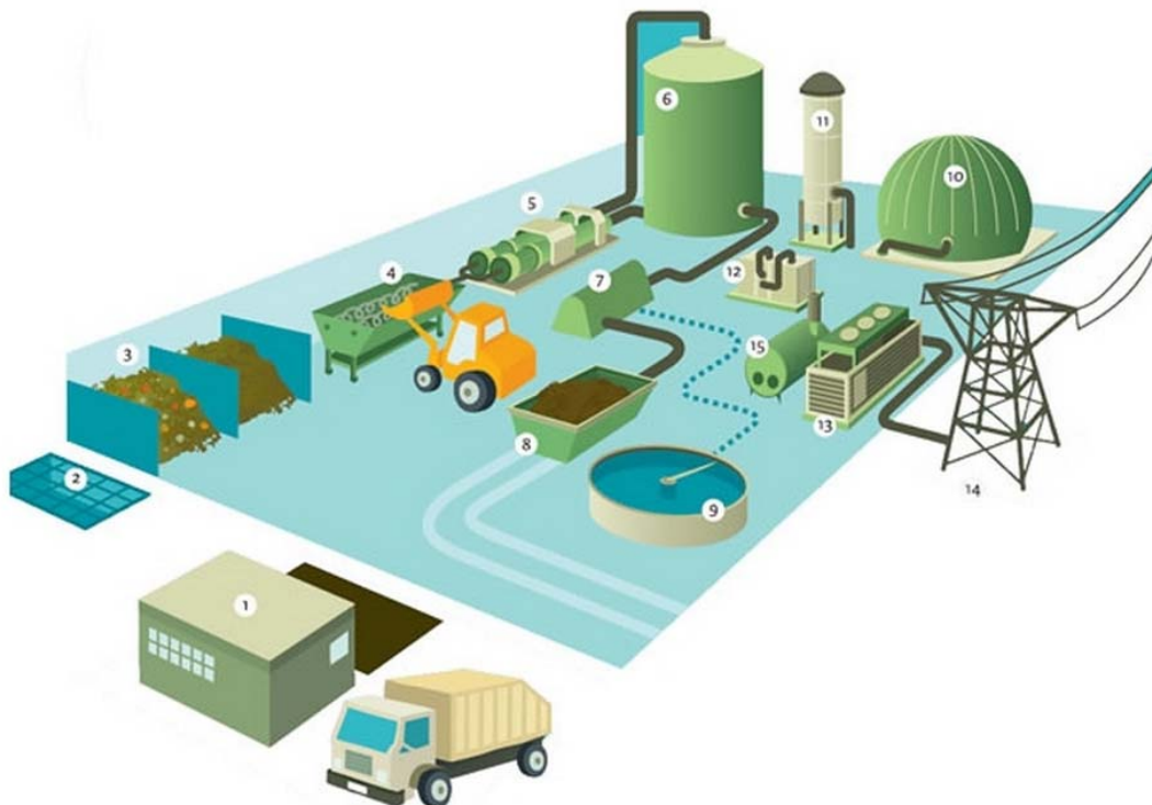
Figura 14. Arreglo general de una planta de DA. Fuente: Agencia de residuos de Cataluña, 2009.
