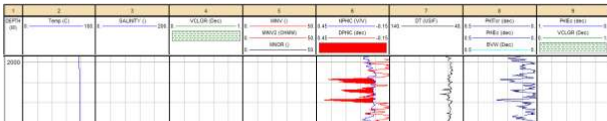
Figura 50. Interpretación petrofísica en intervalo de 2,000 m a 2,030 m en el Pozo 3 (software IP, Senergy).
