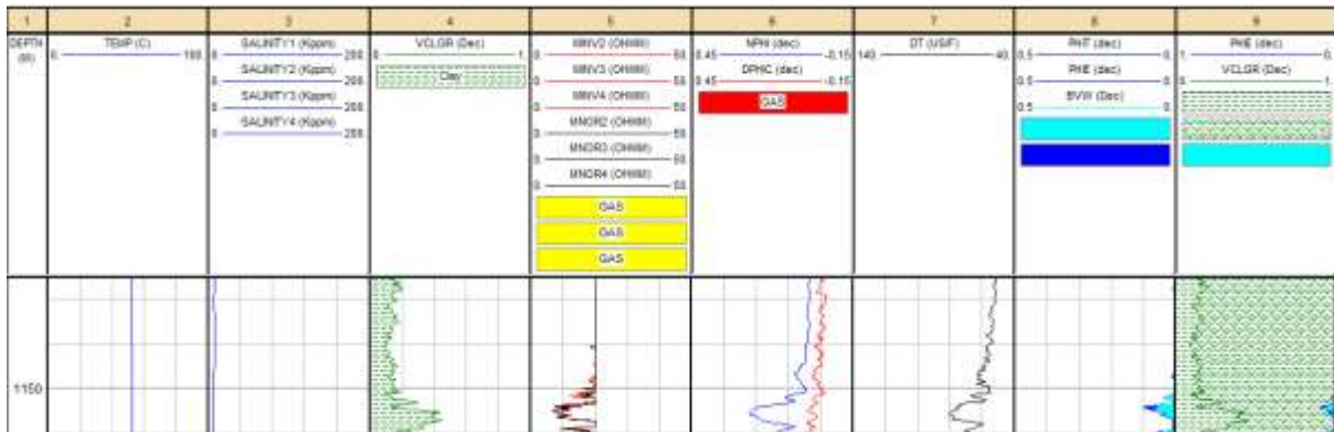
Figura 42. Interpretación petrofísica en intervalo de 1,125m a 1,160 m en el Pozo 2 (software IP, Senergy).
