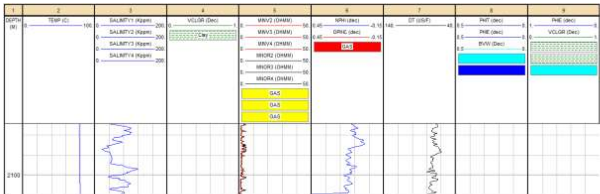
Figura 46. Interpretación petrofísica en intervalo de 2,075 m a 2,110 m en el Pozo 2 (software IP, Senergy).
