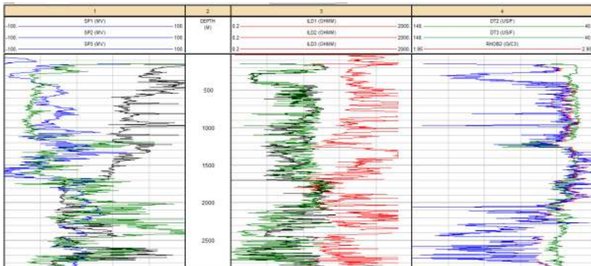
Figura 6. Curvas de registros geofísicos de pozos (software IP, Senergy).
