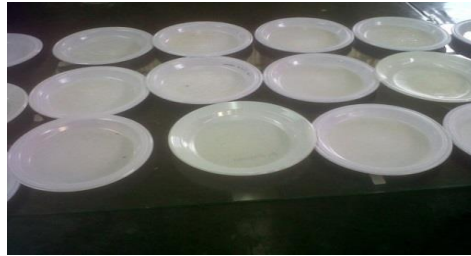
Figura 21.- Secado de las películas comestibles a base de carboximetilcelulosa y mucílago de nopal.
