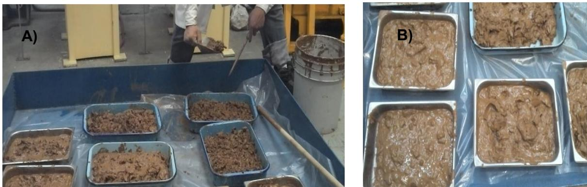
**Figura 13. Preparación de jarosita de llegada para experimentación. A) La muestra contenida en la cubeta fue homogenizada para su tratamiento. B) La muestra fue colocada en las charolas metálicas para su secado.**
