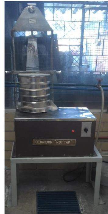
**Figuras 15 y 16. Homogenización (cuarteo) y clasificación de tamaños (Ro-Tap).**
