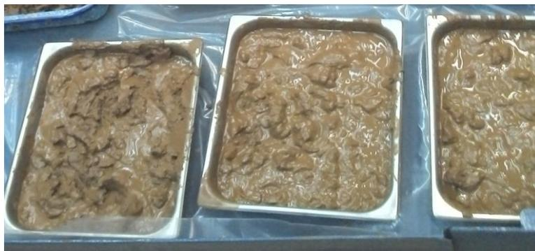
**Figura 5. Lodos de natrojarosita, jales de zinc.**
