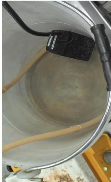
**Figura 17. Acondicionamiento con bomba peristáltica para recirculado de agua durante el enfriamiento.**
