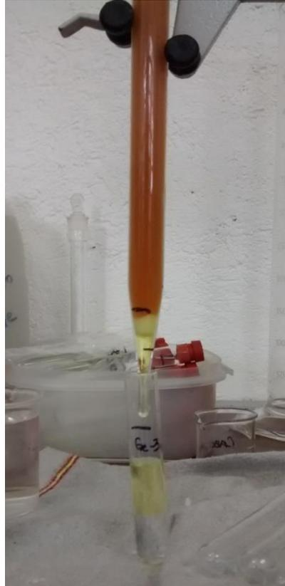
**Figura 20. Toma de muestra durante el proceso de intercambio iónico.**
