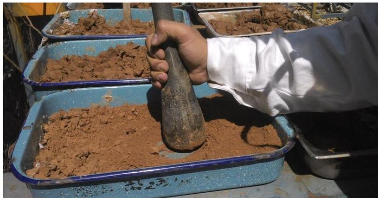
**Figura 14. Eliminación manual de grumos y exposición a la luz del sol para el proceso de secado.**
