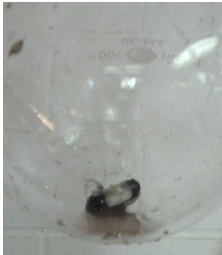
**Figura 35. Óxido de hierro ( $\text{Fe}_2\text{O}_3$ ) obtenido durante la lixiviación sin  $\text{KMnO}_4$ .**
