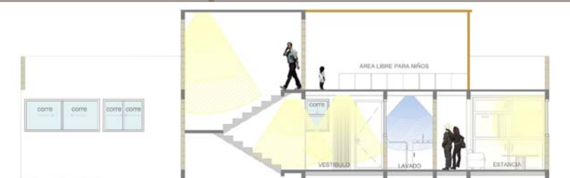
Esquema de iluminación departamentos FUENTE: Desarrollo proyectual del Edificio de Usos Mixtos, Iztapalapa.
