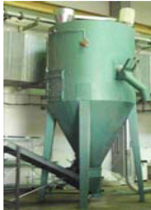
Figura 14. Hidrociclón para separación de diferentes materiales.
