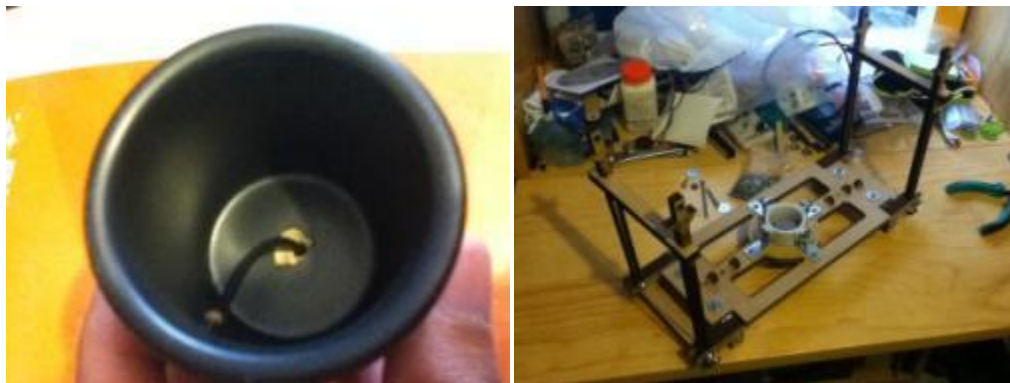
Figuras 3.102 y 3.103. Imagen del crisol modificado mostrando el libre paso del termopar empleado (izquierda). Imagen del sistema con receptor de crisol completamente ensamblado (derecha).
