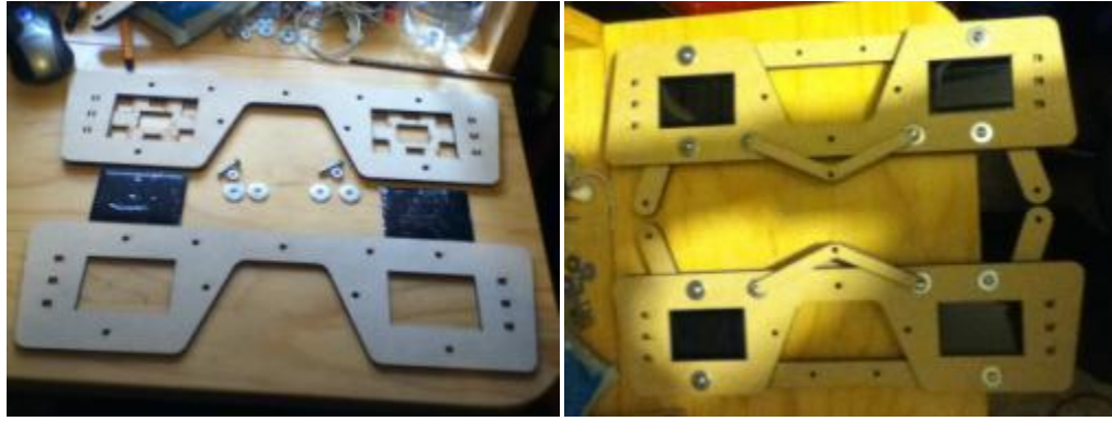
Figuras 3.89 y 3.90. Imagen con las piezas necesarias para el ensamble de la segunda versión (izquierda). Imagen con los dos ensambles que componen al sistema de la segunda versión (derecha).
