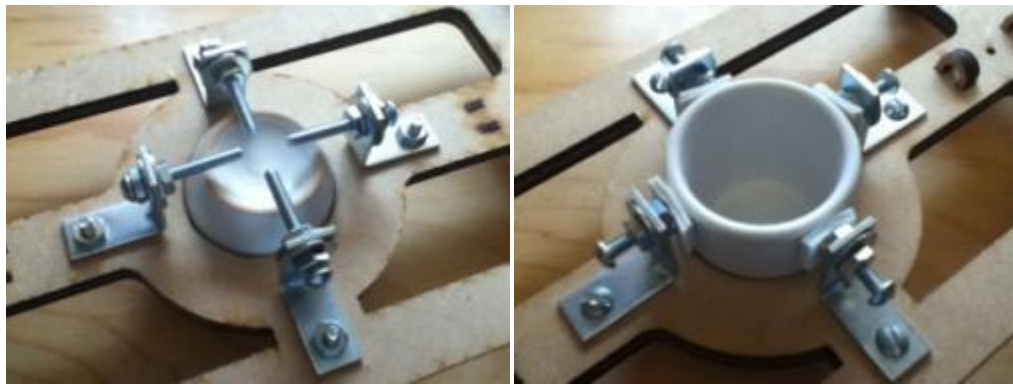
Figuras 3.98 y 3.99. Imágenes mostrando la forma en que se aseguró al crisol en la parte inferior (izquierda) y superior (derecha) de la base del receptor.
