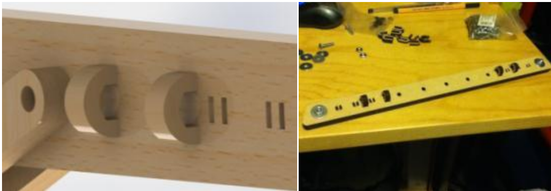
Figuras 3.93 y 3.94. Imagen con un acercamiento al sistema de seguros (izquierda). Imágenes del ensamble completo de la tercera versión (derecha).
