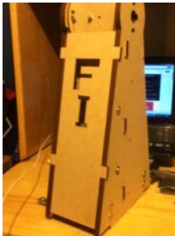
Figuras 3.63 y 3.64. Imágenes de las piezas que cubren al mecanismo del poste: Frontal (izquierda) y Posterior (derecha).
