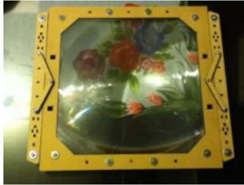
Figura 3.95. Imagen de la tercera versión del sistema de orientación montado en el marco de la lente de Fresnel.
