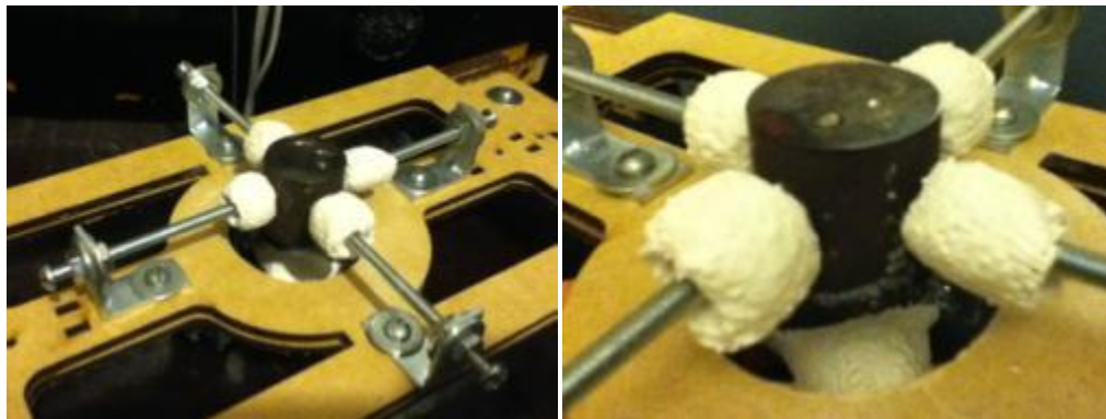
Figuras 3.107 y 3.108. Imagen del sistema receptor vía sujeción (izquierda). Imagen de una probeta de estudio colocada en el receptor vía sujeción (derecha).
