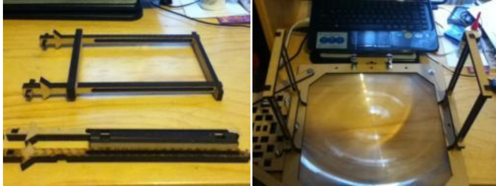
Figuras 3.82 y 3.83. Imagen de las piezas que conforman a la sección de los carriles (izquierda). Imagen de los carriles montados en el marco de la lente (derecha).
