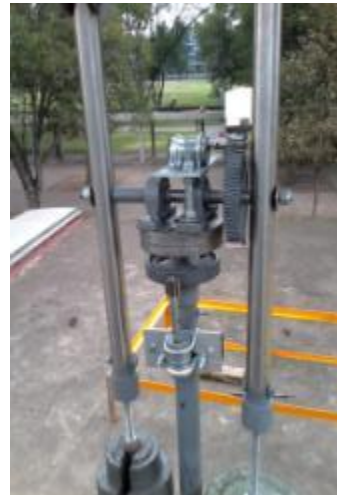
Figuras 13 y 14. Imagen del Concentrador Solar de Disco Parabólico (izquierda). Imagen del sistema y mecanismo de orientación (derecha). [1.5]
