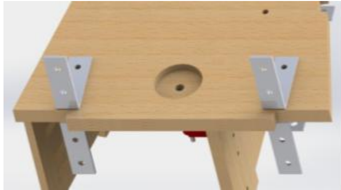
Figura 3.51. Imagen en el software de diseño de los cuatro esquineros que fijarán al poste en la base móvil.
