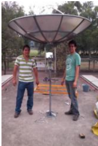
Figuras 13 y 14. Imagen del Concentrador Solar de Disco Parabólico (izquierda). Imagen del sistema y mecanismo de orientación (derecha). [1.5]
