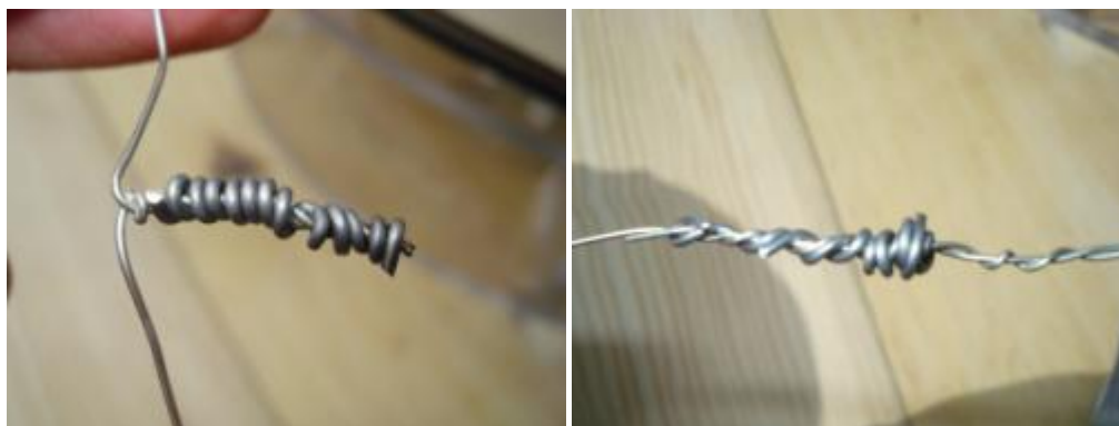
Figuras 4.15 y 4.16. Primera probeta con soldadura de estaño (izquierda), segunda probeta con soldadura de estaño (derecha).
