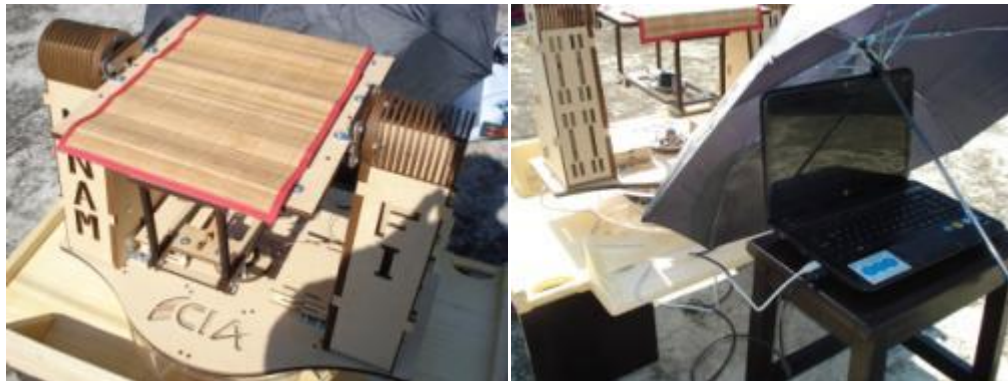
Figuras 4.1 y 4.2. Dispositivo Concentrador Solar con Lente de Fresnel (izquierda) y ordenador (derecha) en el día de la primera prueba.
