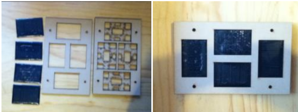
Figuras 3.85 y 3.86. Imágenes de las piezas (izquierda) y ensamble (derecha) de la primera versión del sistema de orientación.
