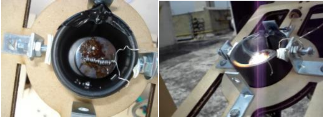
Figura 4.17 y 4.18. Colocación de la primera probeta sobre el crisol y probeta de acero (izquierda). Imagen durante el proceso de unión (derecha).
