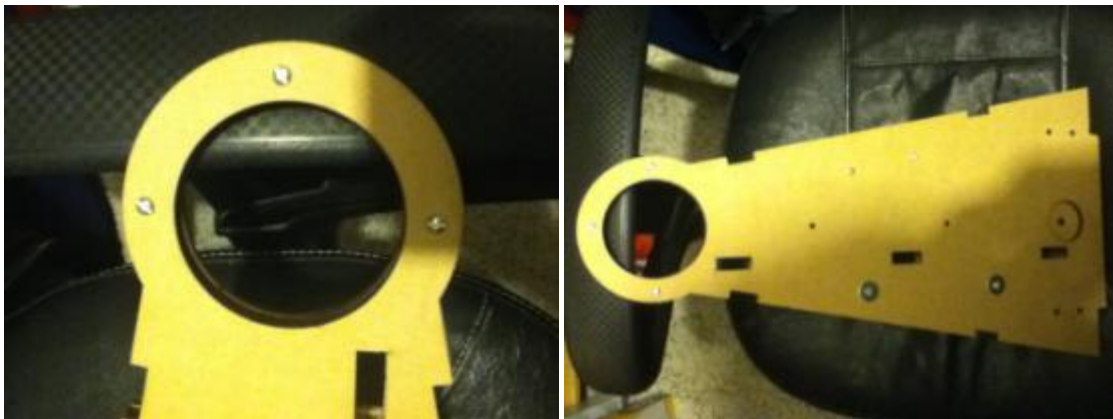
Figuras 3.49 y 3.50. Imagen de la punta con tres tornillos de 1/8" (izquierda). Imagen de la pieza principal del poste con los cinco barrenos adicionales (derecha).
