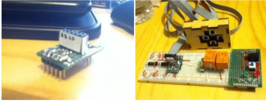
Figuras 3.125 y 3.126. Imagen del conector elaborado para unir el cable del Teach Pendant con el resto del circuito (izquierda). Imagen del circuito de potencia completo (derecha).
