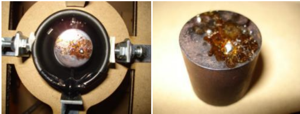
Figuras 4.23 y 4.24. Probeta de acero en el crisol después del experimento de recubrimiento (izquierda). Imagen de la probeta mostrando los resultados (derecha).
