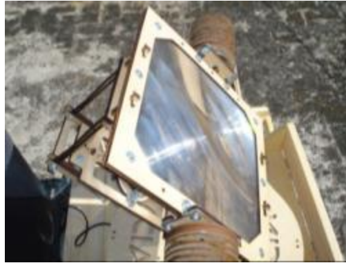
Figura 4.3. Orientación del marco estando perpendicular a la luz solar.
