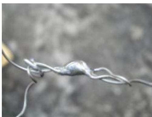
Figura 4.27. Unión lograda en la tercera probeta.
