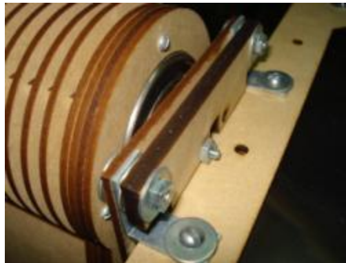
Figura 3.81. Imagen de uno de los lados del marco fijado al sistema del eje.
