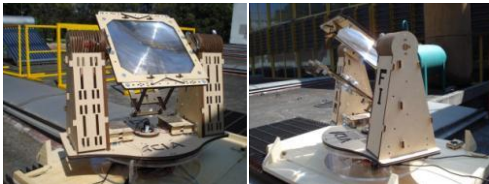
Figuras 4.30 y 4.31. Imágenes del concentrador solar con lente de Fresnel orientado y en funcionamiento durante el tercer experimento.
