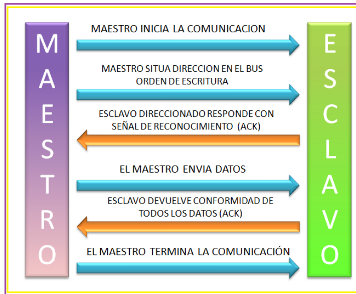
Fig. 2.7.a Transferencia maestro - emisor al esclavo - receptor
