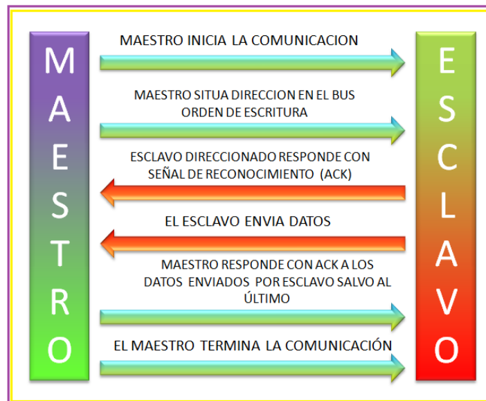
Fig. 2.7.b Transferencia maestro - receptr al esclavo - emisor
