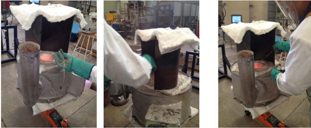
Figura 17. Introducción de termopar para control de la temperatura y atomización directa en el horno con pistola de pintura de agua caliente para la re-introducción del hidrógeno al fundido.
