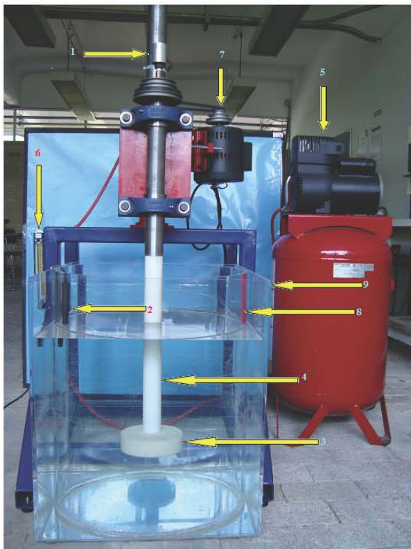
Figura 6. Foto del arreglo experimental de la Figura 4 e instrumentación del reactor: 1. Junta rotativa, 2. Oxímetro, 3. Rotor de Nylamid (liso), 4. Flecha de Nylamid, 5. Compresor, 6. Flujómetro, 7. Motor, 8. Reactor, 9. Recipiente externo del reactor.
