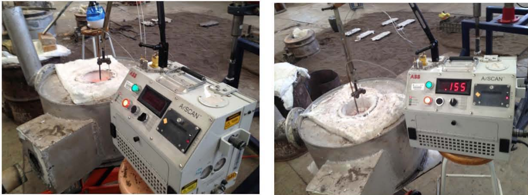
Figura 15. Dispositivo AISCAN en funcionamiento dentro del horno con aluminio líquido.
