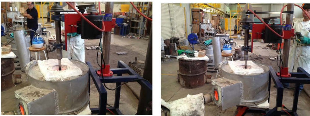
Figura 16. Proceso de degasificación de aluminio con el rotor inyector y la inyección del gas de argón de purga.
