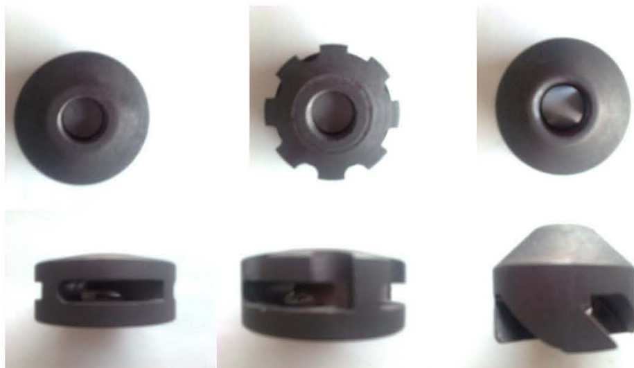
Figura 14. Diseños geométricos de grafito del rotor inyector utilizado en la planta piloto.
