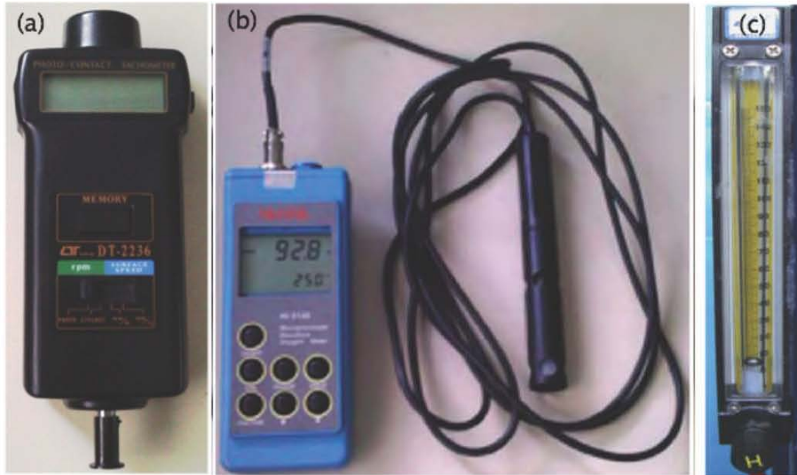
Figura 5. (a) Tacómetro digital, (b) Oxímetro digital, y (c) Rotámetro utilizados en la experimentación del modelo físico.
