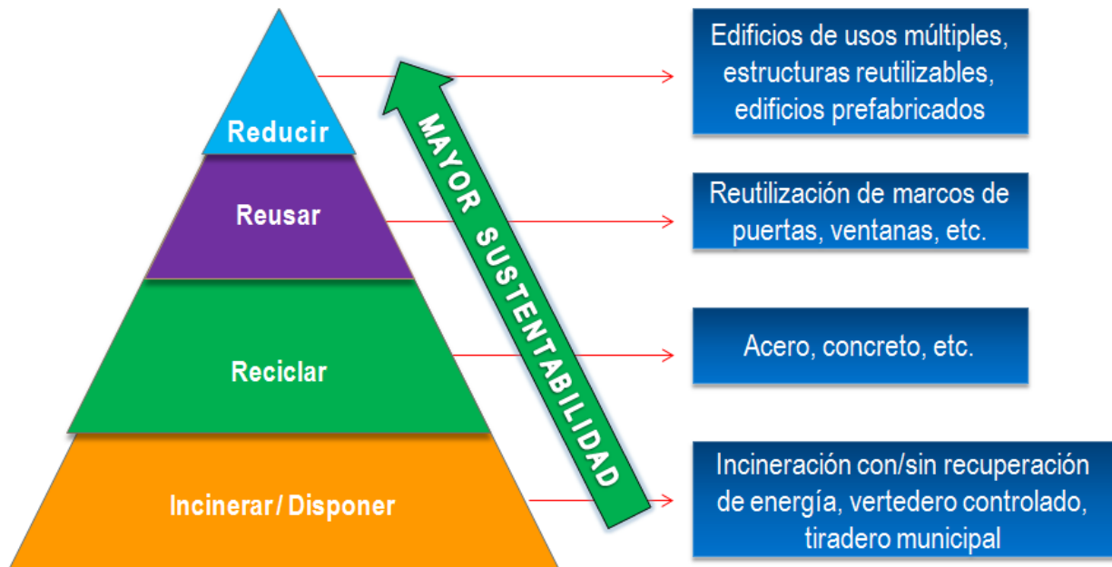
Figura 3. Esquema de Sustentabilidad de los Procesos de las 3 R's, donde se observa que la Reducción de Uso de Materiales debe ser priorizada al Reuso y Reutilización, significando una mayor sustentabilidad ya que se impacta de menor manera al Medio Ambiente por la disminución de Extracción de Materiales Vírgenes. Elaboración por el Autor.
