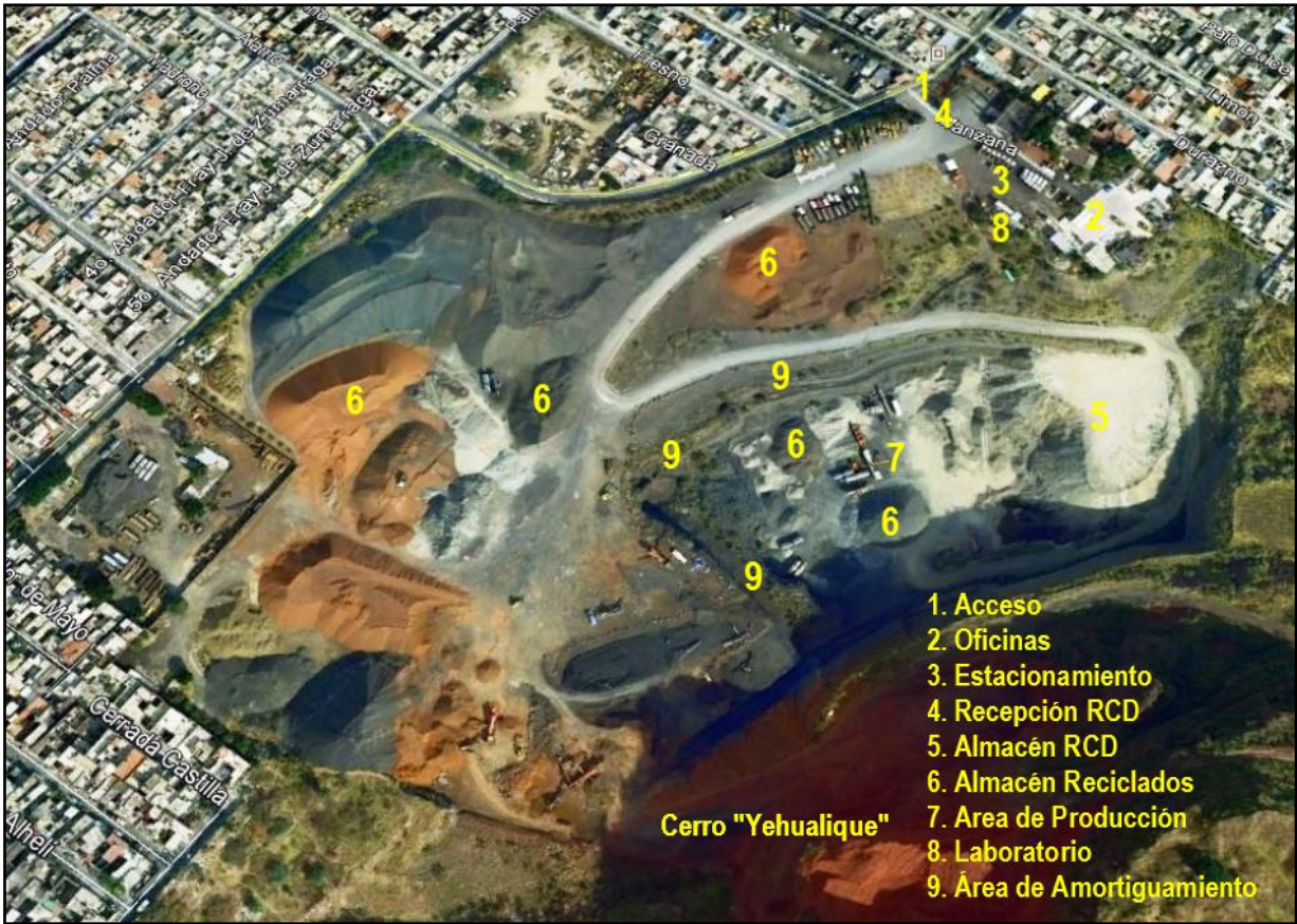
Imagen Aérea 1. Toma aérea de la Planta Procesadora de Residuos de la Construcción “Concretos Reciclados S. A. ubicada en la Delegación Iztapalapa, México, D. F., obtenida de “Google Earth”.
