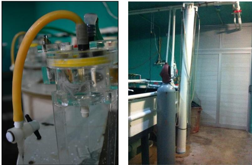
Figura 5. Cámara respirométrica utilizada para la evaluación del consumo de oxígeno de *O. maya* (izquierda). Columna de intercambio de gases acoplada a tanque de nitrógeno (derecha).
