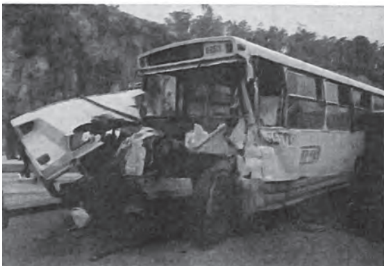
Figura 318. Acercamiento de los daños del autobús de la ruta 100, que presenta alteraciones en la parte frontal media izquierda así como en su vértice por hundimiento hacia atrás y hacia el centro del vehículo, lo que afecta: defensa, tolva, brack, chasis, coraza completa, cofre y unidades de luz, ente otros.
