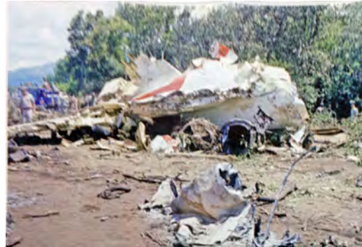
Figura 335. Caso de un carguero que llevaba 22 mil kg de carne y poco después de despegar en la capital de Costa Rica se precipitó a tierra. Se aprecian los efectos de un incendio que la mayor parte se produjo en el fuselaje y zona circundante.
