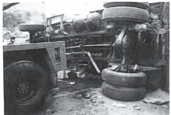
Figura 321. Se aprecia toda la parte inferior del vehículo tipo volteo, el cual se halla sobre un sujeto de sexo masculino que está sobre el asfalto; las bombas de aire de los frenos del camión están dañadas, los neumáticos posteriores derechos se observan semilisos y en mal estado de conservación, además se encuentran trabados por la pérdida de aire de la bomba de los frenos, lo cual se deduce por la fricción de rodamiento que presentan los neumáticos inferiores.
