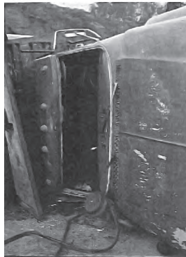
Figura 317. Vista de frente del camión volcado: sobre el costado derecho se aprecia dañada la cabina así como desprendimiento del parabrisas y de la portezuela derecha; esta última con hundimiento hacia la izquierda.
