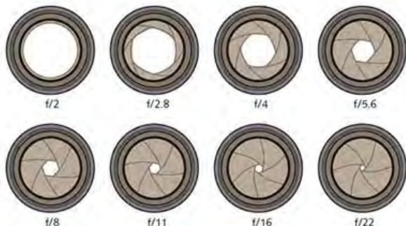
Figura 28. Imagen de diferentes aberturas de diafragma
