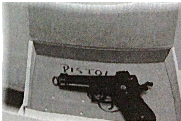
Figura 447. En una caja de cartón que sea 5 cm mayor a la medida del arma con orificios para su fijación
