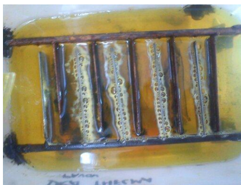
Fig.3.5. a) Generación de hidrogeno en cátodo
