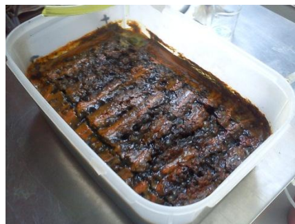
Fig. 3.4. a) Muestra con presencia en exceso de hidroxido ferroso b) Reactor con 24 placas
