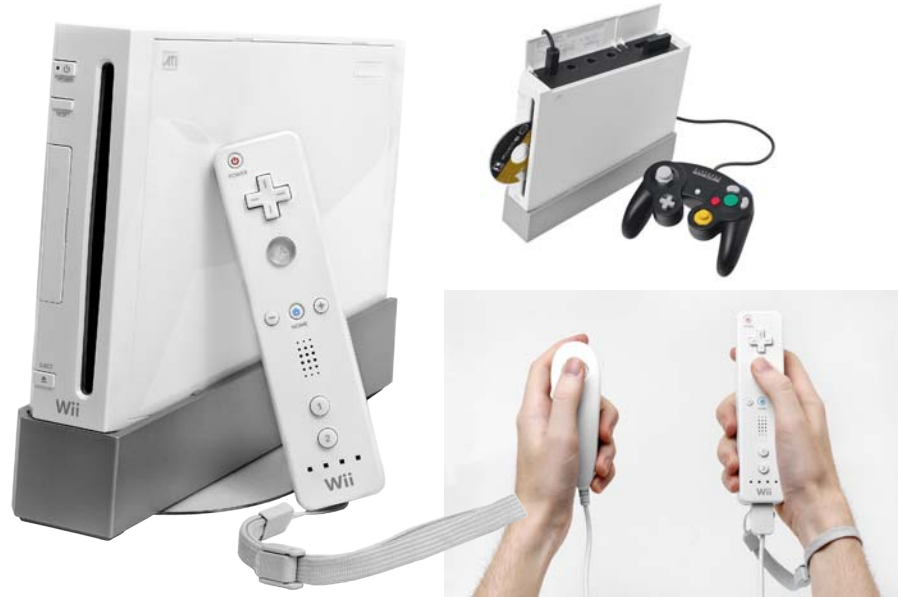
Imagen 1.168. Wii de Nintendo. La consola con el Wii remote, una demostración de cómo se usan el Nunchuk y el Wii remote, y las entradas para conectar memorias y accesorios del GameCube.
