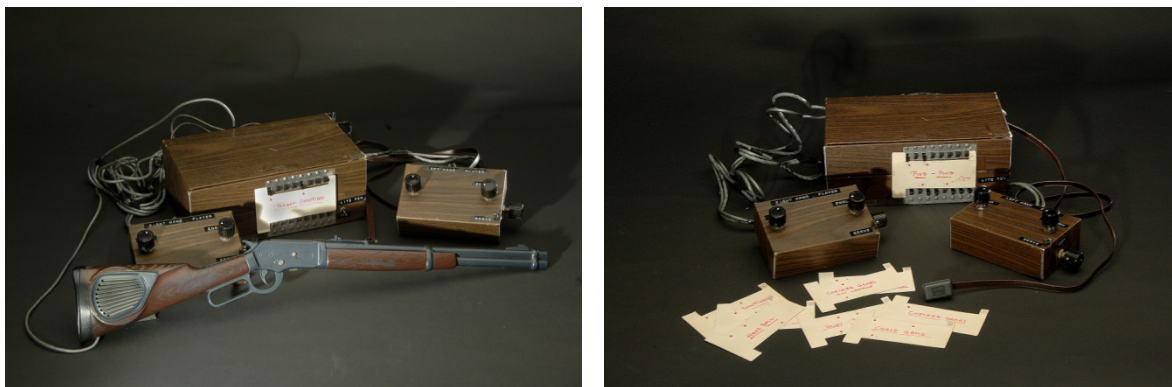
Imagen 1.5. La Brown Box de Baer. A la izquierda con el rifle óptico, y a la derecha con la tarjeta que indica en qué posición deben ponerse los switches para jugar ping-pong.
