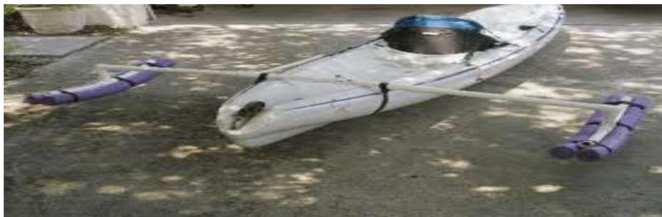
**Figura 1. Estabilizador elaborado de tubos de PVC y popotes de natación.**
