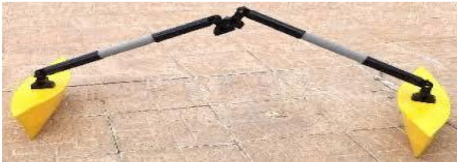
A continuación en la figura 1. Se muestran el modelo base del estabilizador. Pueden elaborarse con tubos de PVC y popotes de natación.
