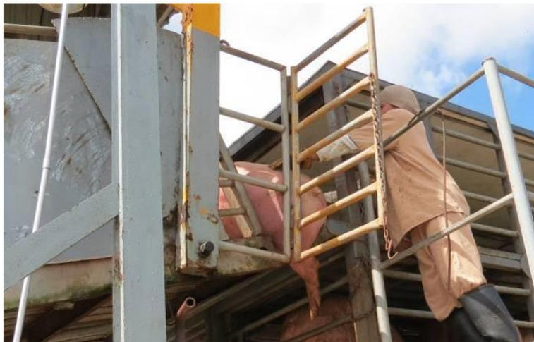
Foto 34. Espacios entre pisos y paredes de rampa y camión pueden ocasionar lesiones en los animales y comprometer la seguridad de los operarios.
