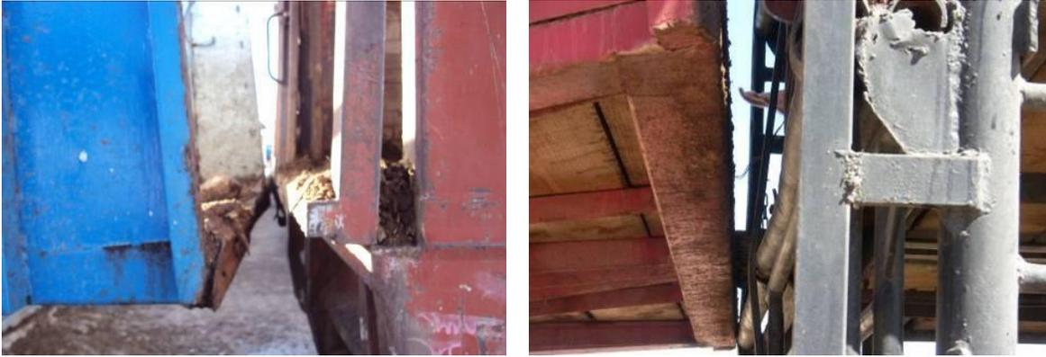
Fotos 32 y 33. Es importante que pisos y paredes de rampa y camión coincidan perfectamente entre sí.
