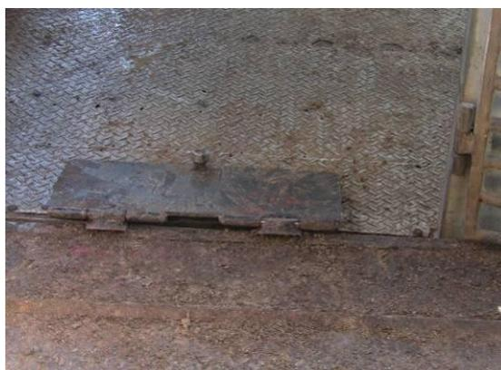
Fotos 35 y 36. Para evitar separaciones entre los pisos del camión y rampas se observó el uso de pestañas entre estos.
