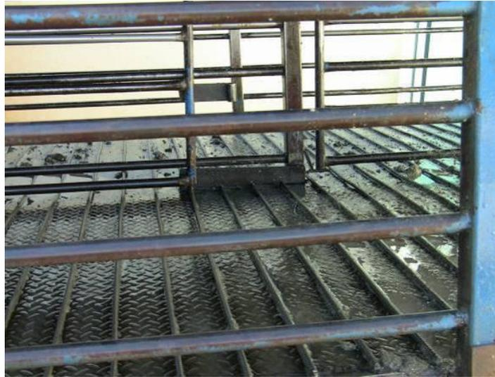
Foto 17. Listones unidireccionales en piso de camiones
