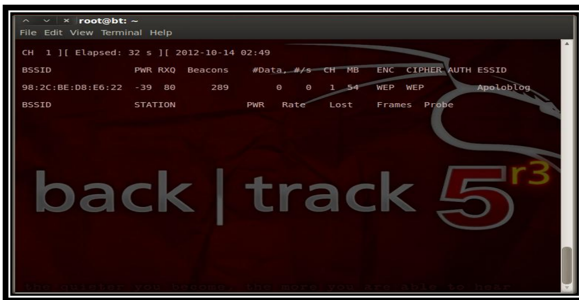
Ilustración 27 Captura del comando "airodump-ng -c 1 --bssid 98:2C:BE:D8:E6:22 -w crackwep mon0"
