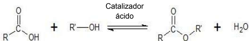
Figura 2.1 Esquema general de la reacción de esterificación de un ácido graso con alcohol en presencia de un catalizador ácido.
