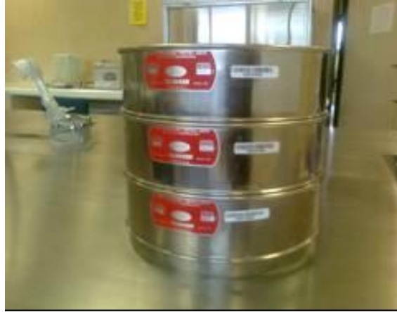
Figura 18. Tamiz con tres diferentes tamaños de malla.
