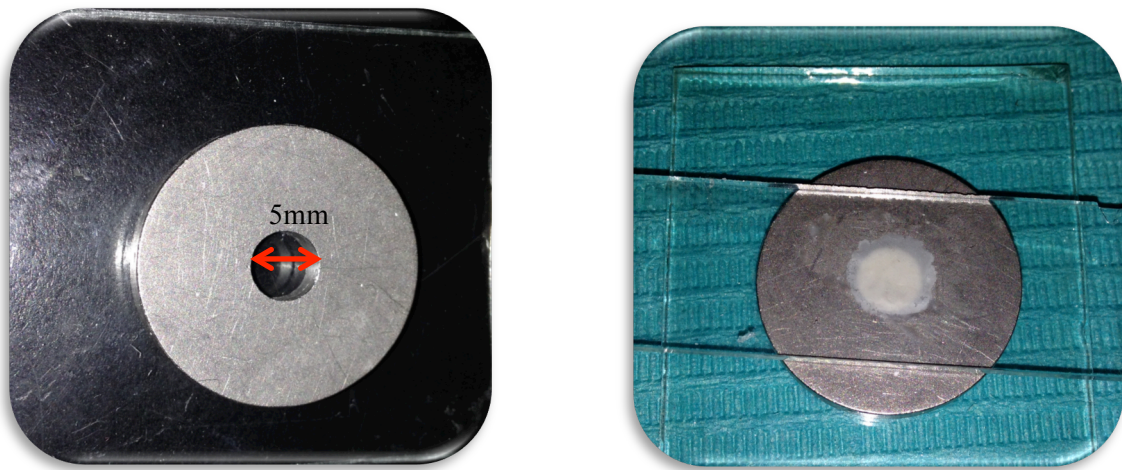
Figura 35. Molde para preparación de muestras de dureza. Figura 36. Molde con la muestra.
