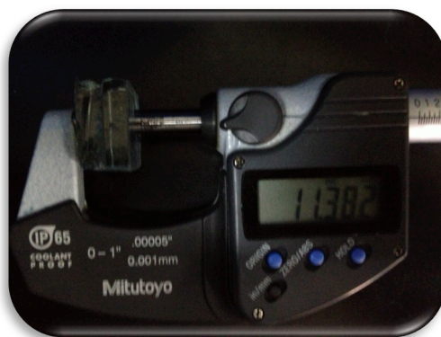
Figura 46. Medición de la lectura A del espesor de los vidrios.
