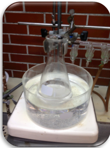
Figura 14. Baño de agua del extracto a 90^{\circ}\text{C} \pm 5^{\circ}\text{C} en tolueno.
