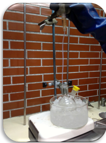
Figura 7. Mezcla de reacción de la sal de sodio de la beta alanina y adición de cloruro de metacrililo gota a gota a 0-5°C en un baño de hielo.
