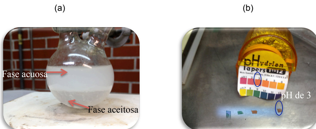
Figura 9 (a) y (b) . Separación de fases de la solución por acidificación (a). Medición cualitativa de pH de la solución (b).
