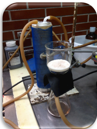
Figura 19. Dispositivo de recristalización. El embudo buchner filtra el sólido obtenido y elimina el hexano. El disolvente se atrapa en una trampa de vidrio sumergida en nitrógeno líquido al vacío. Figura 20. Cristales blancos de metacrililo beta alanina MBA.
