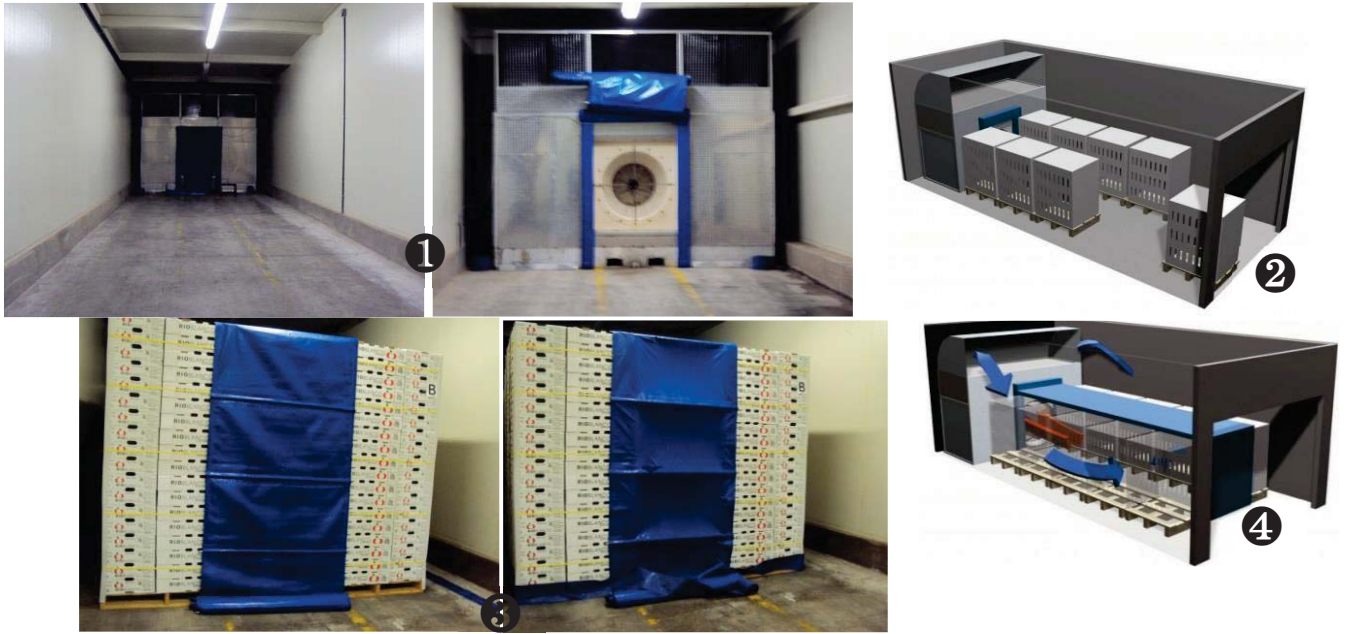
Fig. 76. Preenfriamiento de la fruta: 1) Cámara frigorífica y ventilador, 2) Colocación de pallets en dos hilera, 3) Colocación de lona y 4) Circulación de aire frío y caliente dentro del túnel 1 .
