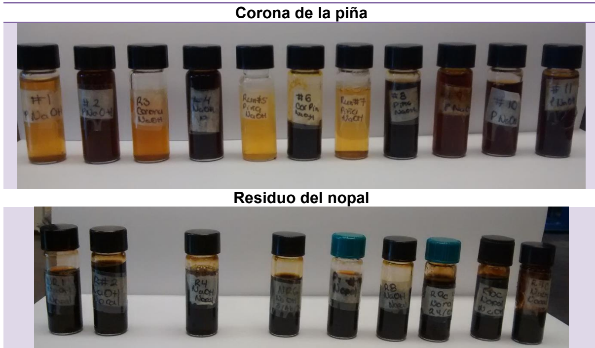
Figura 5.3: Licor obtenido después del pretratamiento hidrotérmico/alcalino en las pruebas en el residuo agroindustrial. (Corona de la piña de izquierda a derecha prueba: 1, 2, 3, 4, 5, 6, 7, 8, 9(C), 10(C) y 11(C). Residuo del nopal de izquierda a derecha prueba: 1, 2, 4, 6, 7, 8, 9(C), 10(C) y 11(C)).
