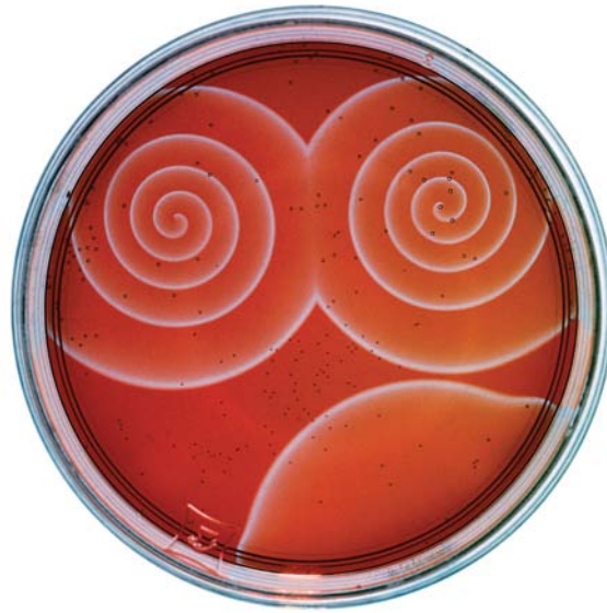
Figura 1.1: Reacción de Belousov Zhabotinsky: esta reacción se comporta como un oscilador no lineal. la concentración de las sustancias que contiene oscilan, lo que da lugar a un oscilador químico.
