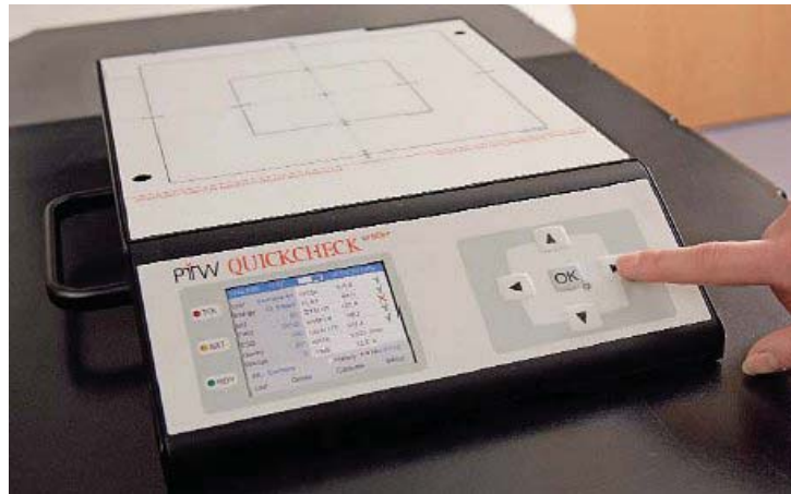
Figura 2.2. Dispositivo “Quickcheck”(marca PTW) con el que se realiza la verificación matinal diaria de los haces de radiación, en el acelerador lineal.
