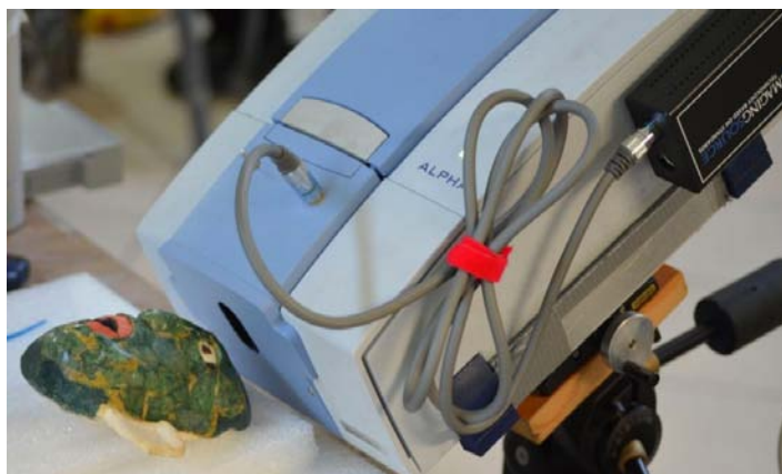
Fig. 42. Equipo portátil de Espectroscopia Infrarroja utilizado en el estudio de lítica mesoamericana
