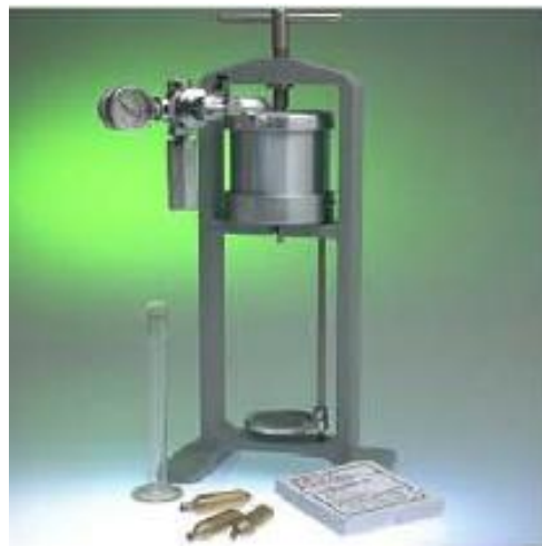
Figuras 7 y 8. Filtro prensa para determinar el filtrado en un fluido de perforación.
