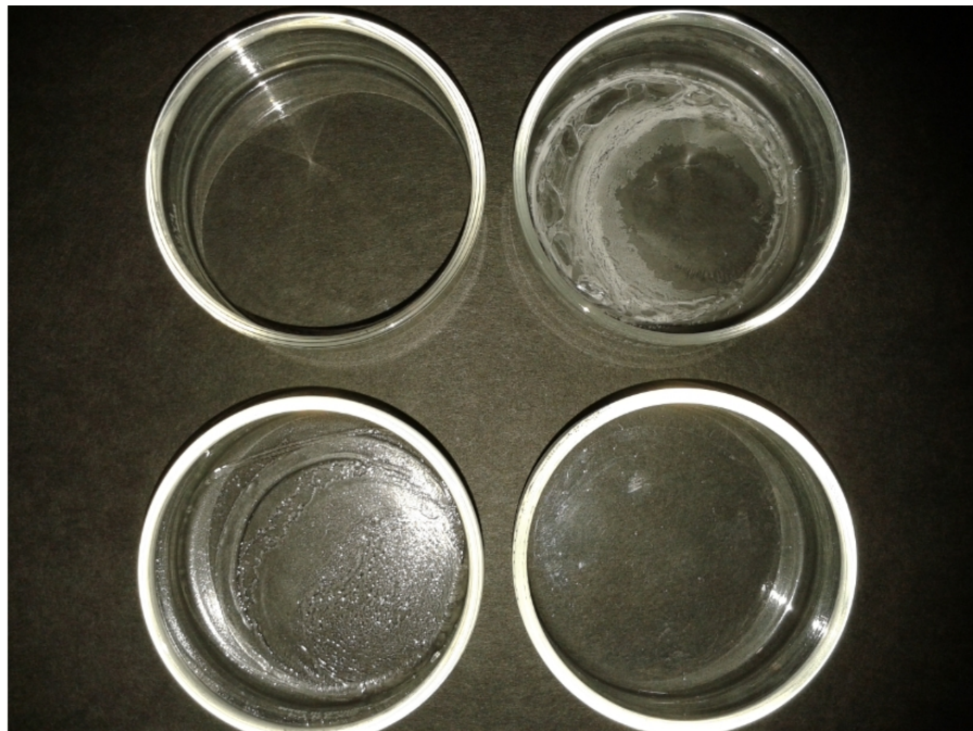
Figura 4.2 Membranas E (sup izq), G (sup der), F (inf izq) y C (inf der) con TBEP como plastificante.
