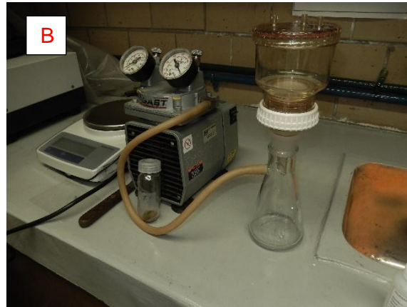
Figura 5.5 Centrifugador y bomba de vacío con filtro acoplado
