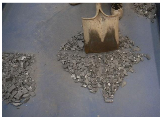
Figura 5.4. Cuarteo y homogeneización de la roca
