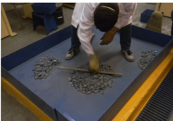
Figura 5.4. Cuarteo y homogeneización de la roca
