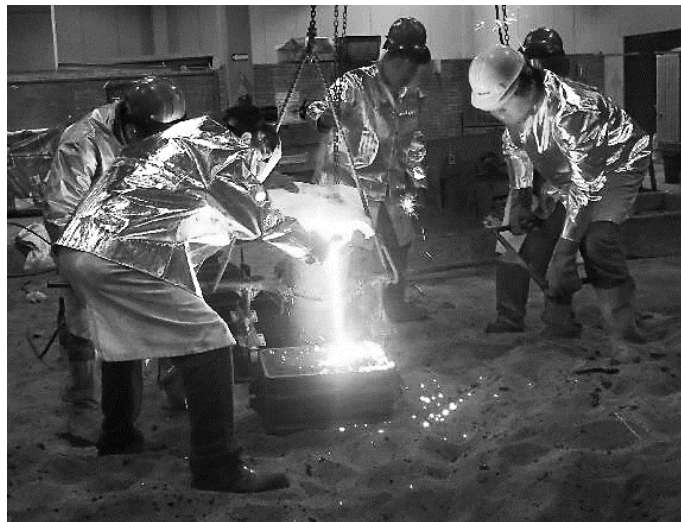
Figura 3.1. Llenado de un molde de arena con la aleación líquida obtenida, Métodos A y C
