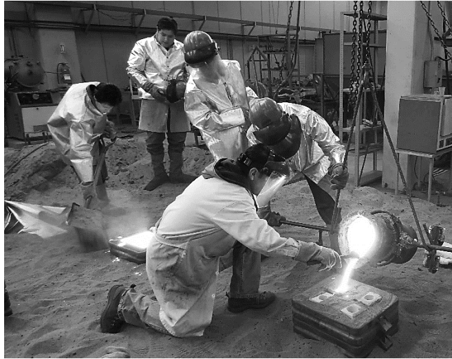
Figura 3.2. Vaciado en moldes de Silicato/CO 2 . Método B.
