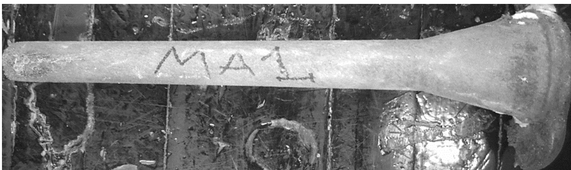
Figura 4.3. Piezas producidas para el método B, las barras cilíndricas fueron cortadas y preparadas metalográficamente para su evaluación microestructural, la barra es del mismo tamaño que las del método A y C. Piezas similares fueron trabajadas mecánicamente para llevar a cabo ensayos de tracción.
