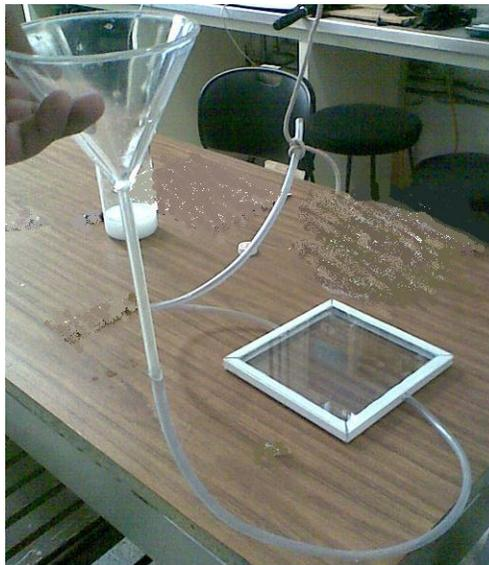
**Figura 5.4.** Fotografía del Aparato construido con dos placas de vidrio unidas por un soporte de aluminio, alimentadas y drenadas por medio de mangueras.
