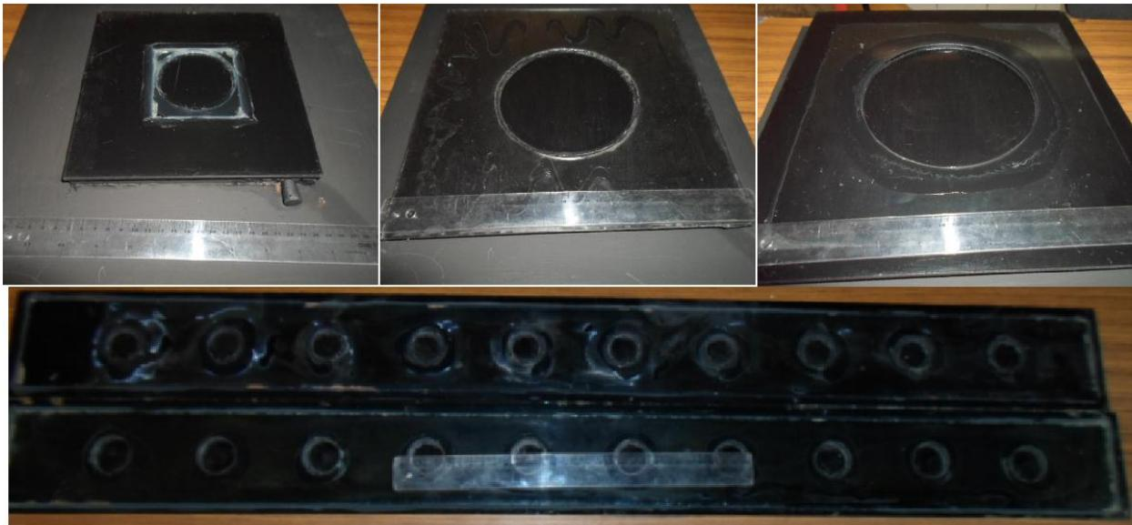
**Figura 5.9.** Diversos dispositivos construidos de forma circular con diámetros 18 cm, 15 cm, 7.5cm y 3.8cm. Los grosores disponibles son 2,3,4,5,6,8 y 10 milímetros (sólo se muestran algunos representativamente)
