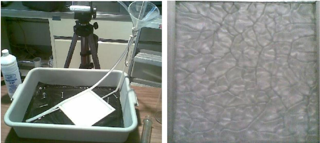
**Figura 6.3** Experimento sobre agua a temperatura ambiente. Arriba se vierte alcohol para provocar el gradiente de temperatura. La sustancia de trabajo es alcohol,  $Ra \approx 244000$
