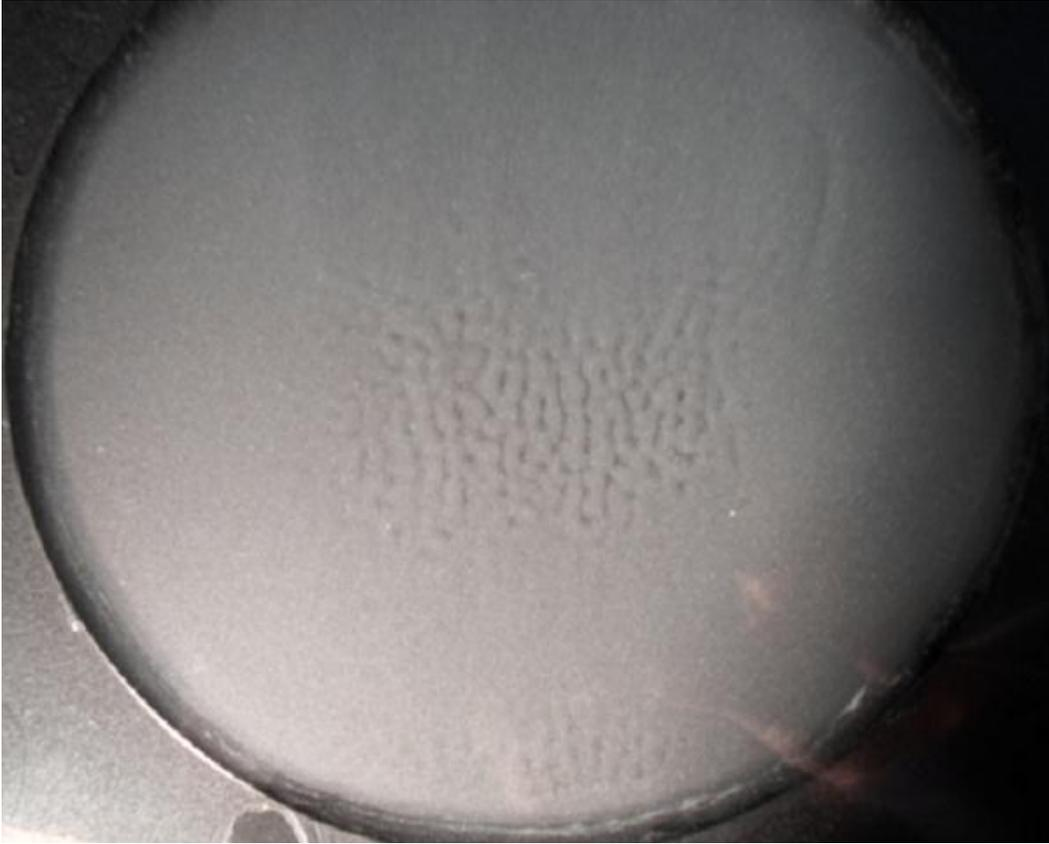
**Figura 6.10** Inestabilidades en una separación de 2mm, con alcohol como fluido de trabajo. en un contenedor circular de 15 cm de diámetro.  $\Delta T = 10^{\circ}\text{C}$ ,  $Ra \approx 4100$ .
