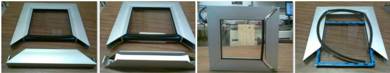
**Figura 5.5.** Construcción de recipiente con cancelería de aluminio.
