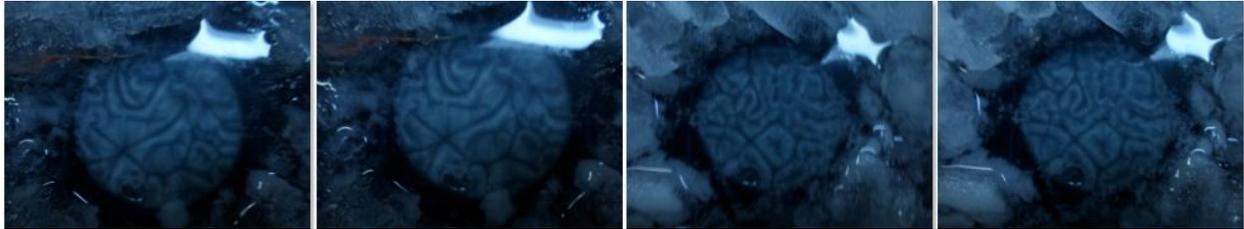
**figura 6.8** Experimento con hielo por debajo y hielo con sal por arriba. Sustancia de trabajo: alcohol,  $\Delta T = 6.5^\circ\text{C}$ ,  $d=6\text{mm}$ ,  $Ra \approx 72100$ . Las dos imágenes de la izquierda tienen un desfase temporal de 10 minutos de las dos imágenes de la derecha.
