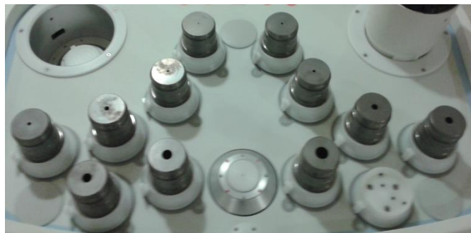
Figura 3.10. Colimadores circulares con diámetros de 5 mm hasta 60 mm.
