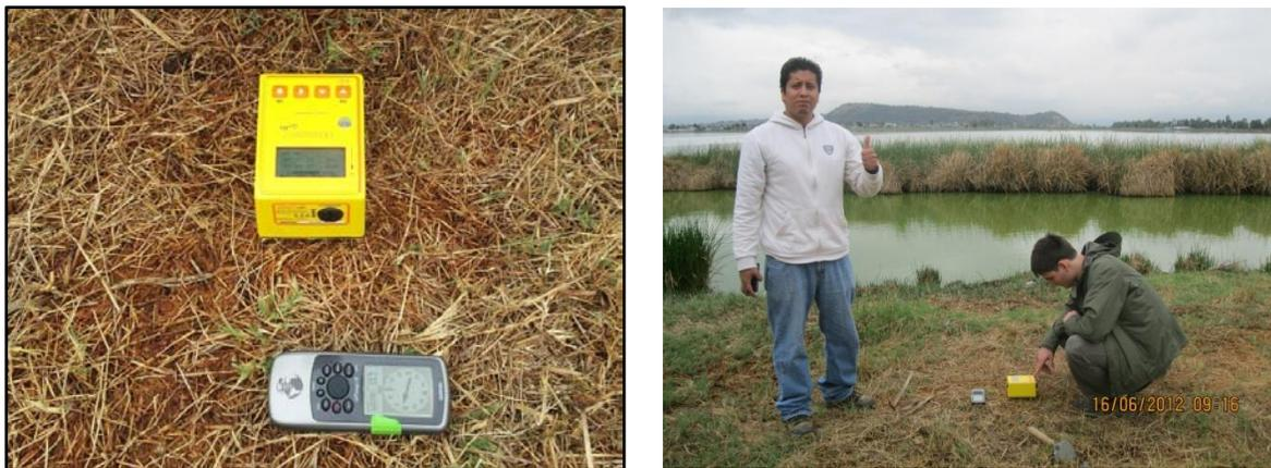
Figura 3.3: Equipo de registro Tromino® y GPS con los que se llevo a cabo la adquisición de datos sobre el ejido de Santiago Tulyehualco.
