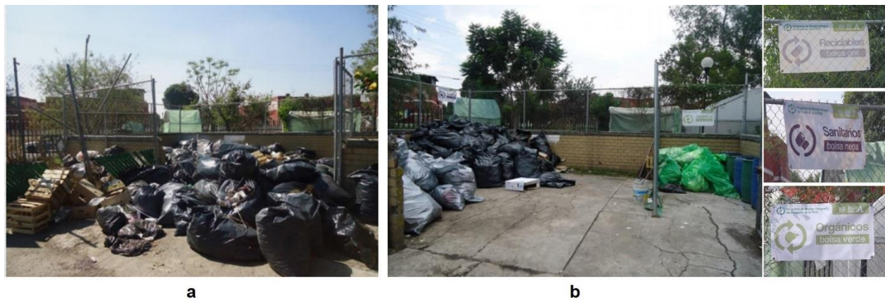
Figura 31. a) Artesa antes de iniciar el programa. b) Artesa modificada para el almacenamiento de residuos con espacios separados, del lado derecho de la fotografía se muestran los letreros para identificar el tipo de residuo.
