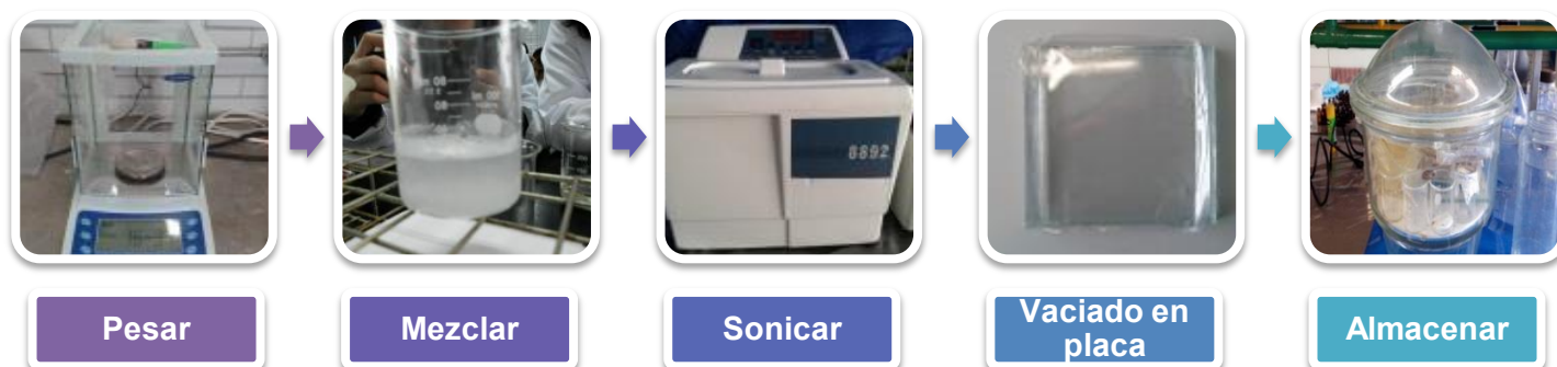
Figura 13. Proceso de fabricación de Parches Transdérmicos de Losartán.
