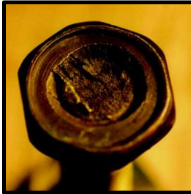
Fig.4.11: Corte transversal de falla analizada caso 4 [16]
