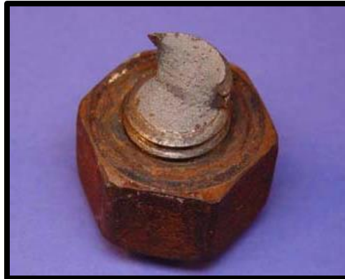
Fig.2.9: Fractura frágil flexión en tornillo [IDDP].
