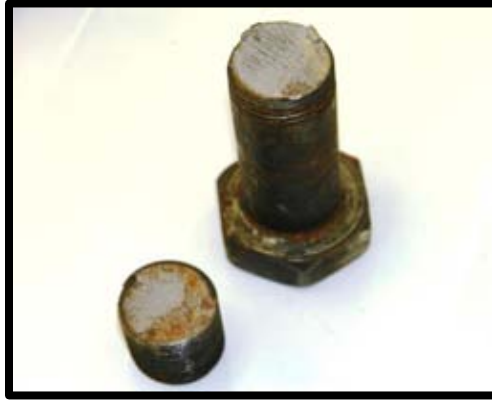
Fig.2.7: Ejemplo de fractura frágil [UDIATEM].
