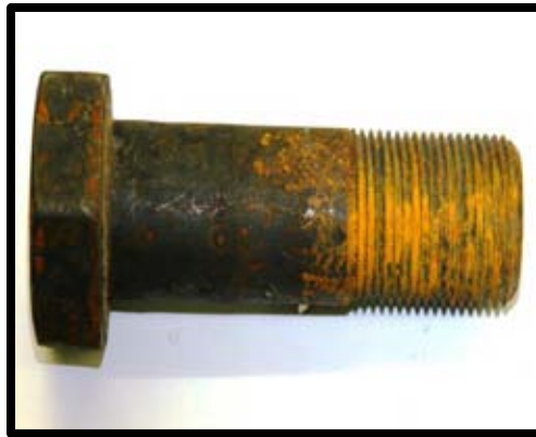
Fig.2.11: Ejemplo de corrosión en elemento mecánico [UDIATEM].
