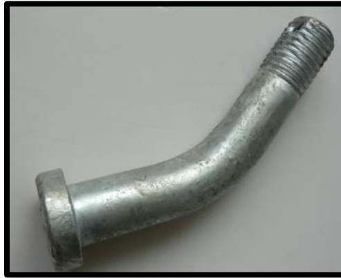
Fig.2.25: Falla por deformación a flexión en tornillos [IDDP].
