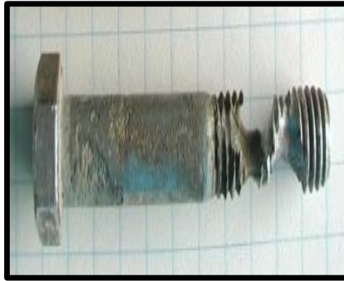
Fig.2.14: Falla por corrosión por picadura en tornillo [IDDP].
