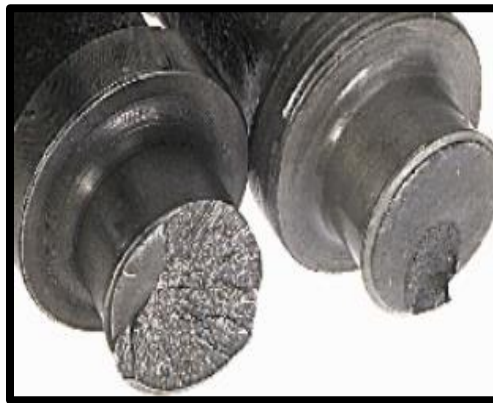
Fig.2.21: Ejemplo de fractura por fatiga [IDDP].
