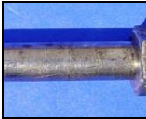
Fig.2.15: Falla por ludimiento en tornillos [IDDP].
