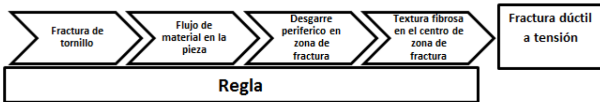
Fig.3.6: Ejemplo de una regla de inferencia sobre análisis de falla en tornillos ferrosos.
