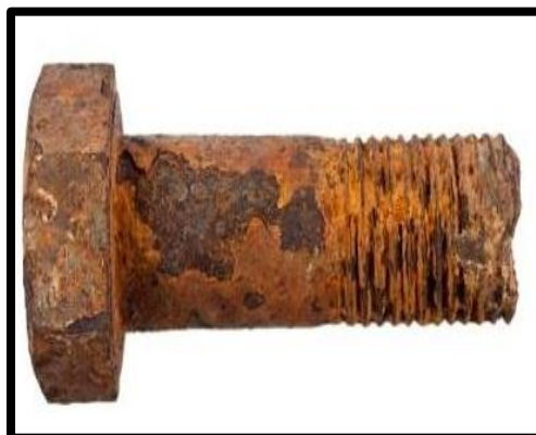
Fig.2.13: Falla por corrosión uniforme en tornillo [IDDP].
