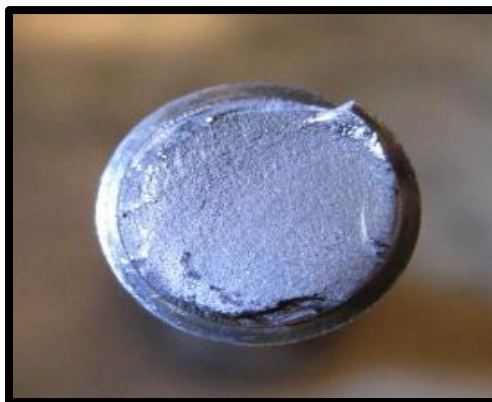
Fig.2.8: Fractura frágil a tensión en tornillo [IDDP].
