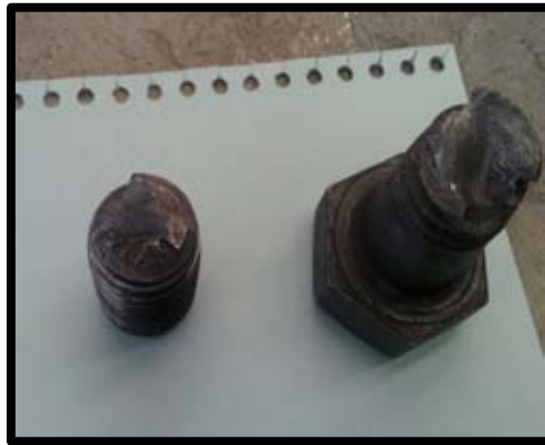
Fig.2.10: Fractura frágil a tensión torsión en tornillo predominantemente fibrosa [UDIATEM].
