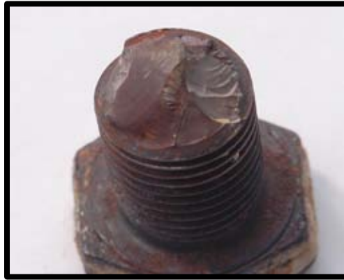
Fig.2.22: Falla por fractura por fatiga a flexión [UDIATEM].
