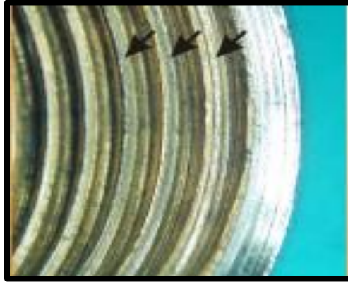
Fig.2.19: Falla por desgaste de tuerca en tornillo [IDDP].
