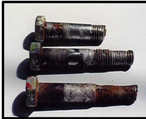
Fig.2.12: Falla por corrosión general en tornillos [IDDP].
