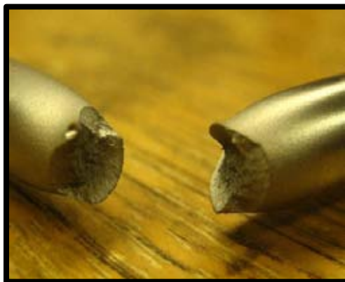
Fig.2.4: Ejemplo de fractura dúctil [IDDP].
