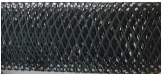
*Figura 9.* Ánodo de titanio recubierto con la mezcla de SnO<sub>2</sub>-Sb<sub>2</sub>O<sub>5</sub>-RuO<sub>2</sub>.
