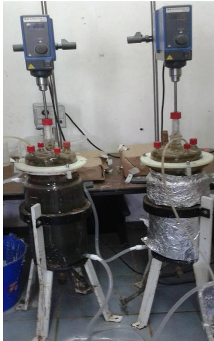
*Figura 8.* Reactores para digestión anaerobia.
