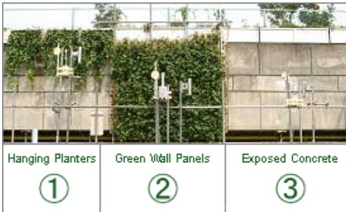
Imagen 26: Colocación de los instrumentos de medición, en las diferentes variables de muros con y sin vegetación. Hoyano, A. 1998, Tokio. Fuente: <http://www.sinergia3.com>
