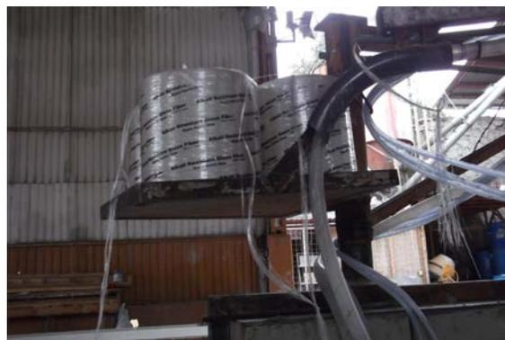
Imagen 61: Rollos de la fibra de vidrio que se mezcla con el mortero.
