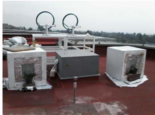
Imagen 95: Medición de temperaturas al interior de los módulos con diferente especie trepadora.
