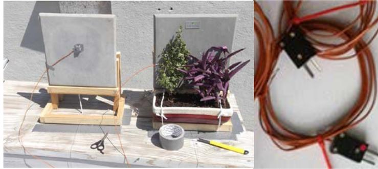
Imagen 85: Colocación de termopares tipo J en la superficie de las placas.
