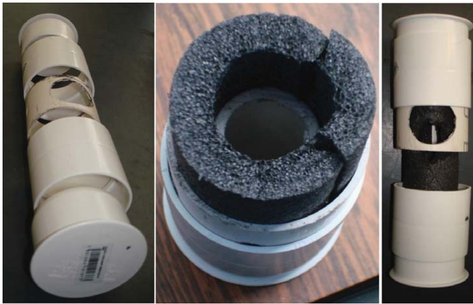
Figura 4.14: Fotografía de las piezas con las cuales se construyó la montura M3. Se observa el recubrimiento interior de hule espuma que se utilizó para proteger la celda y fijarla dentro de la montura M3.
