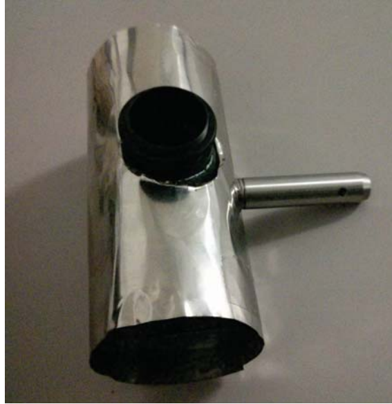
Figura 4.15: Fotografía de la montura M3 ya terminada. La montura ya está pintada de negro mate, forrada por una capa de metal \mu y con el poste colocado para fijarla a la mesa óptica. En el agujero frontal se observa que ya está pegado el tubo SM1V05 con plastilina epóxica.
