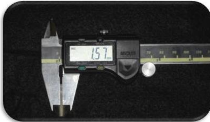
Figura no. 23. Medición de ancho y grosor de la muestra con el Vernier.
