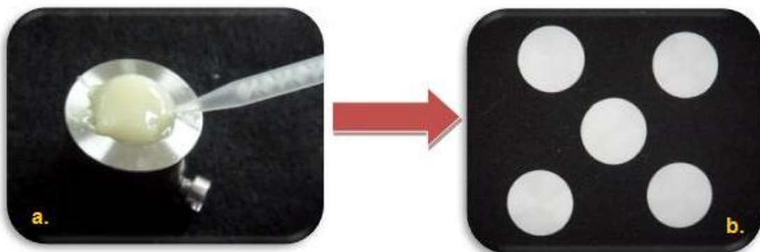
Figura no. 11. a. Molde para sorción de agua y solubilidad en agua b. Muestras para sorción acuosa y solubilidad en agua
