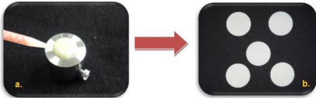
Figura no. 12. a. Molde para Estabilidad de Color b. Muestras para Estabilidad de Color
