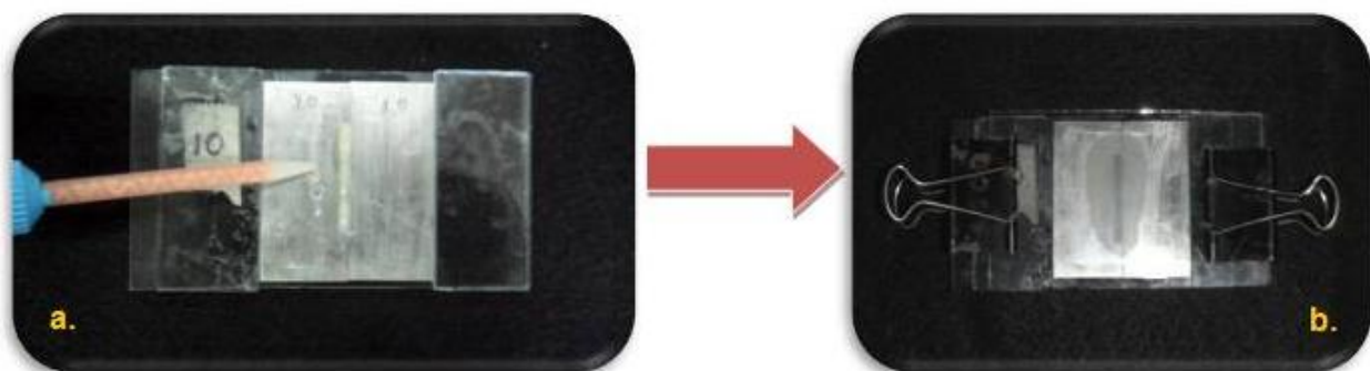
Figura no. 18. a. Automezclado de la resina bisacrílica b. Molde ensamblado.
