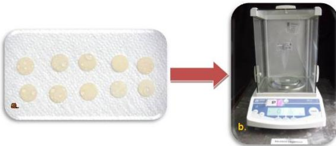
Figura no. 34. a. Muestras lavadas con agua y secadas antes de ser pesadas b. Muestras pesadas en la balanza analítica.
