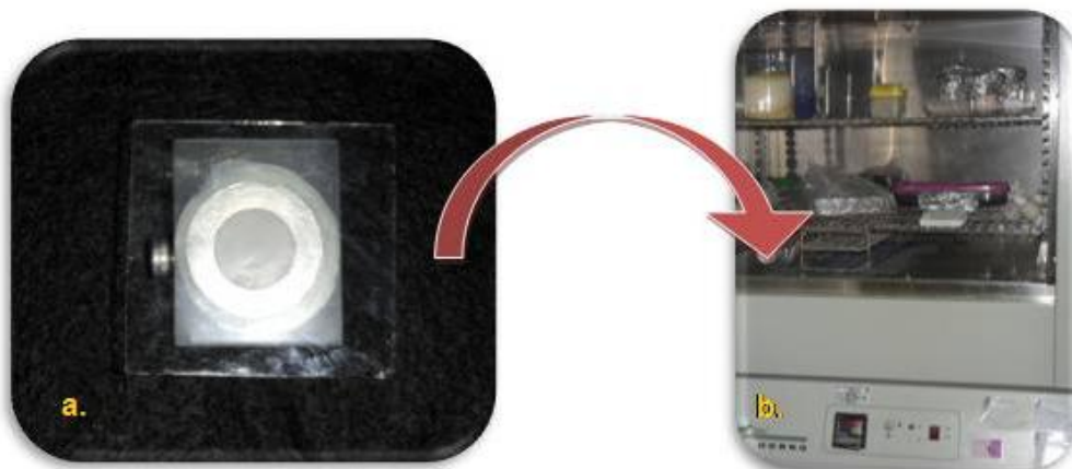
Figura no. 26. a. Colocación de la cinta Mylar y la laminilla de vidrio sobre la mezcla b. Colocación de la muestra en el horno Felisa® a 37°C
