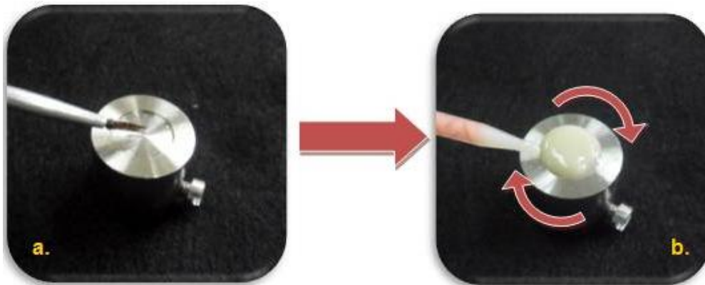
Figura no. 25. a. Colocación de aceite de silicona como separador b. Mezclado de la resina bisacrílica y la colocación con movimientos circulares en el molde.
