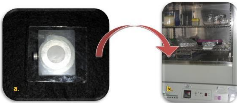
Figura no. 37. a. Colocación de la cinta Mylar y la laminilla de vidrio sobre la mezcla b. Colocación de la muestra en el horno Felisa® a 37°C
