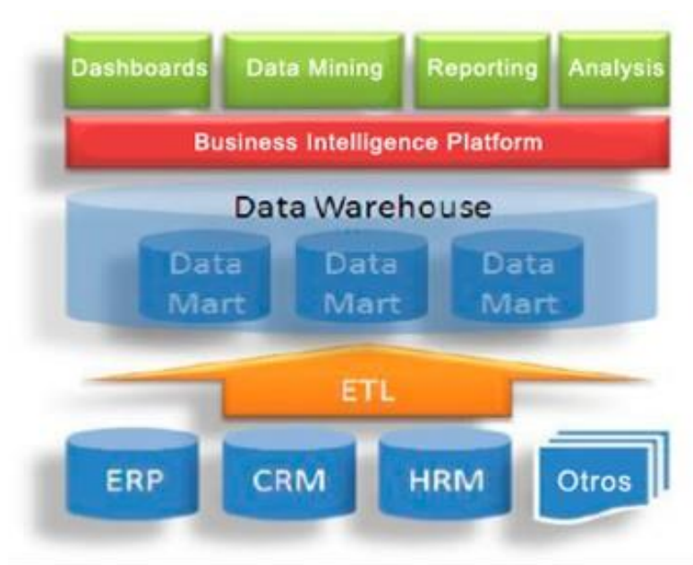
FIGURA 3.3.2. Esquema de la arquitectura de Pentaho
