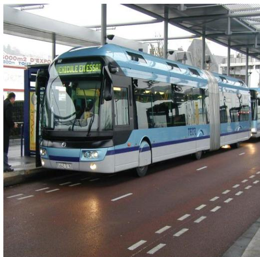
**Figura 2.3 Autobús con Sistema de Autoguiado Óptico de Rouen, Francia**
