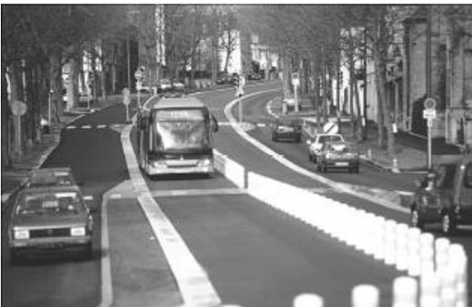
**Figura 2.5** Carril Segregado del Sistema BRT de Rouen, Francia
