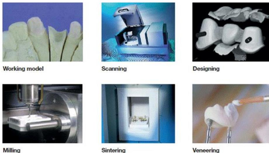
Fig. 50 Pasos para la elaboración de restauraciones en el sistema CAD-CAM.<sup>31</sup>
