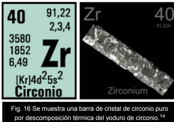
Fig. 16 Se muestra una barra de cristal de circonio puro por descomposición térmica del yoduro de circonio.<sup>14</sup>
