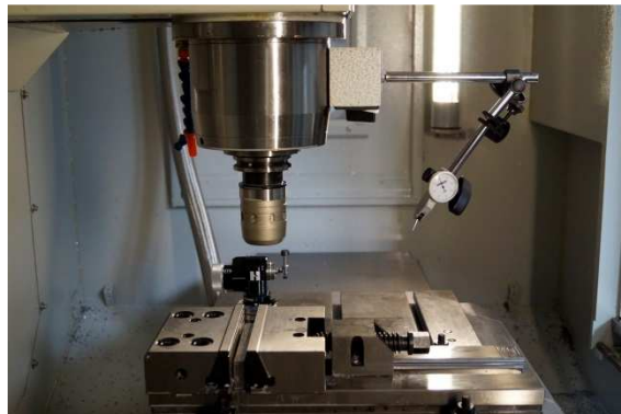
Figura 3.7 Conjunto base magnética-articulación-indicador de carátula
