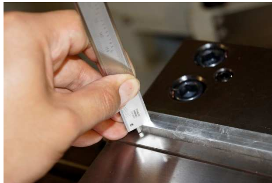
Figura 3.12 Verificación de 4mm para el corte
