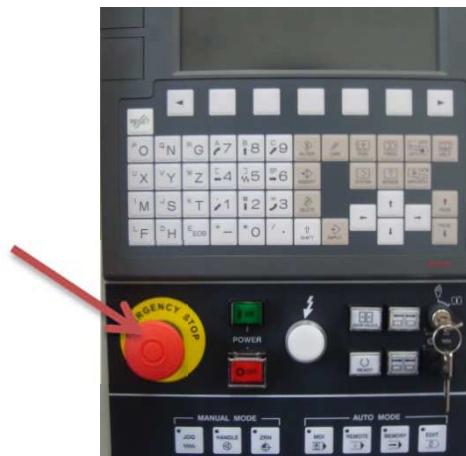
Figura 6. Se señala la ubicación del botón de paro de emergencia (naturalmente cerrado)
