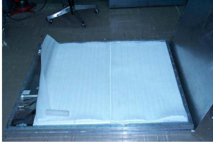
Figura 2.2: Fotografía de uno de los plásticos centelladores usados en el experimento, con la caja de aluminio destapada, las cubiertas de unicel y plástico reflejante cubren a la placa transparente del centellador, imagen tomada de [18].
