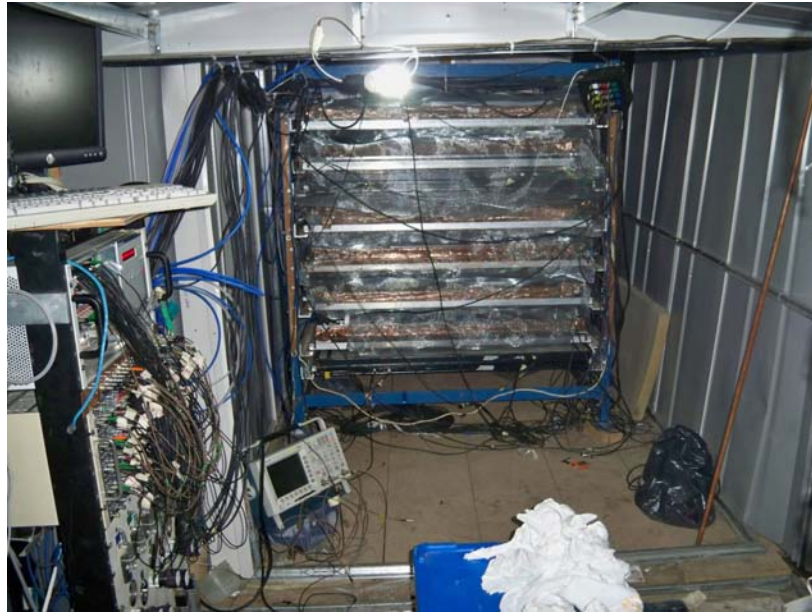
Figura 2.1: Fotografía del detector completo ya instalado en la cueva debajo de la pirámide, en la parte izquierda se distingue la electrónica para la adquisición de datos.
