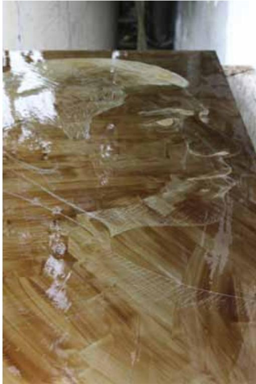
Figura 44. Lavado de la lámina al chorro de agua.
