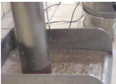
Figura 21. Recolección de zinc en celda primaria de zinc
