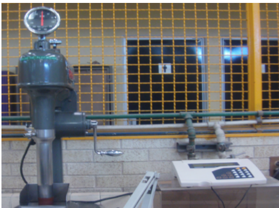
Figura 18. Celda de flotación y pH - metro
