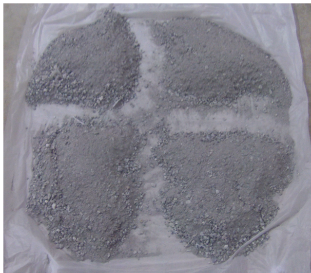
Figura 11. Cuarteo del mineral
